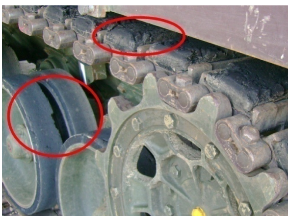
Figura 22- Almofadas e rodas de apoio degradadas
