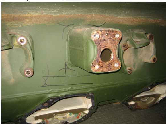
Figura 24- Fendas identificadas no casco do CC Leopard 2A6
