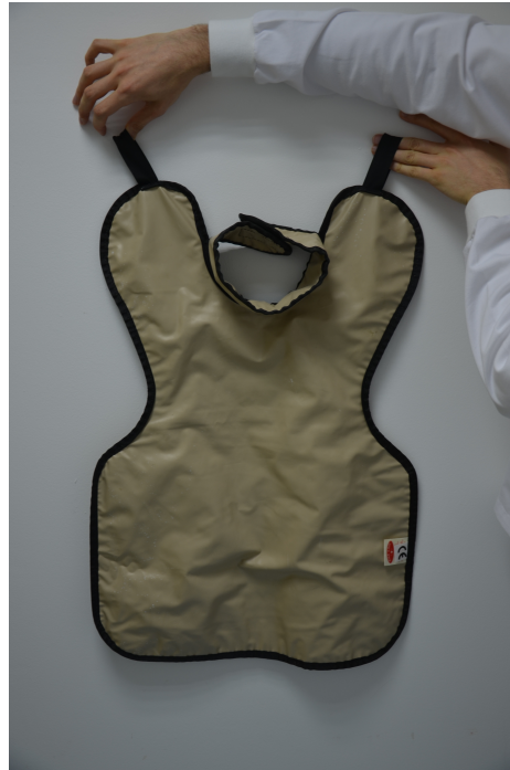
Figura 3.17 - Exemplo de uma avental de chumbo com colar cervical
