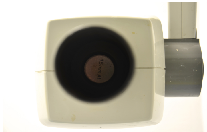
Figura 3.4 - Exemplo de uma cabeça de aparelho de radiografia intraoral com o filtro de alumínio de 1,5 mm
