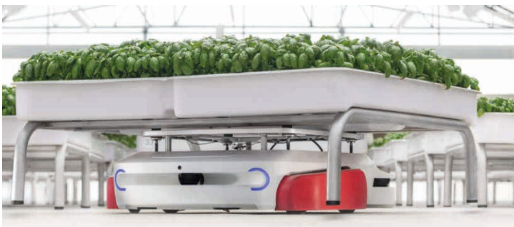
Figura 30. Detalhe do mais recente robô de transporte autônomo de tabuleiros de cultivo em utilização. Fonte: https://ironox.com/
