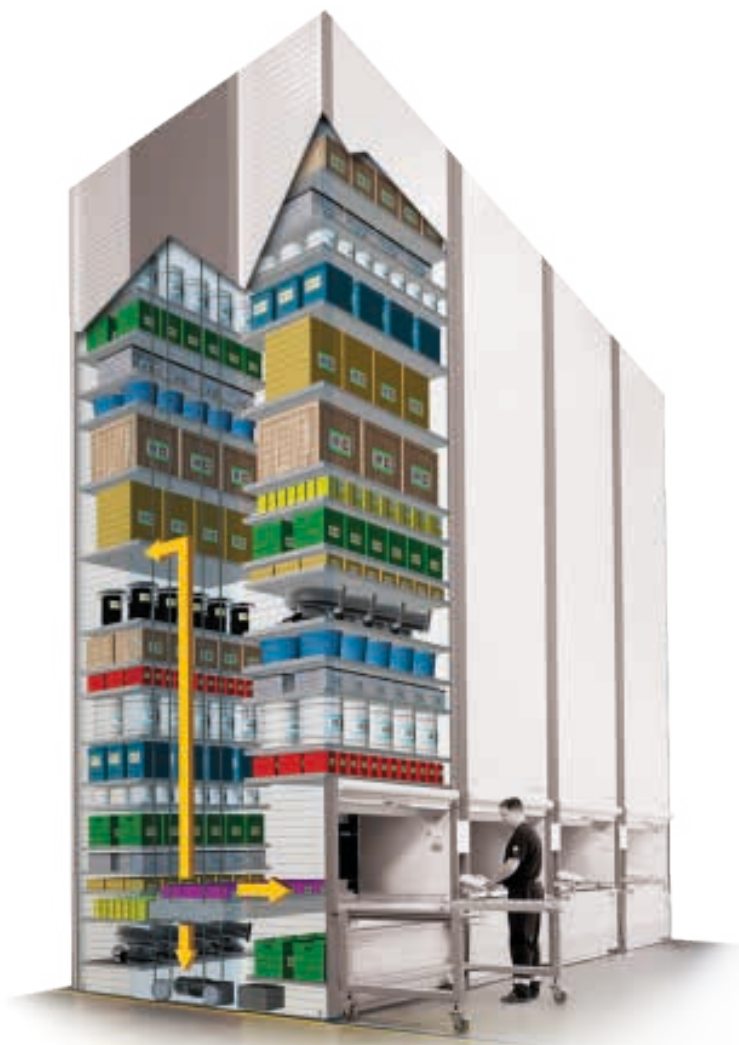
Figura 32. Infografia representativa do funcionamento de um armazém vertical. Fonte: https://www.industore.co.uk/hanel-lean-lift/
