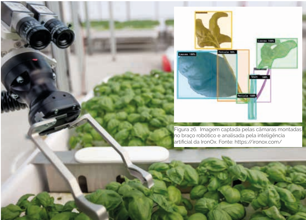
Figura 27. Braço robótico utilizado pela IronOx para transplantar, movimentar e monitorizar toda a produção. Fonte: https://ironox.com/
