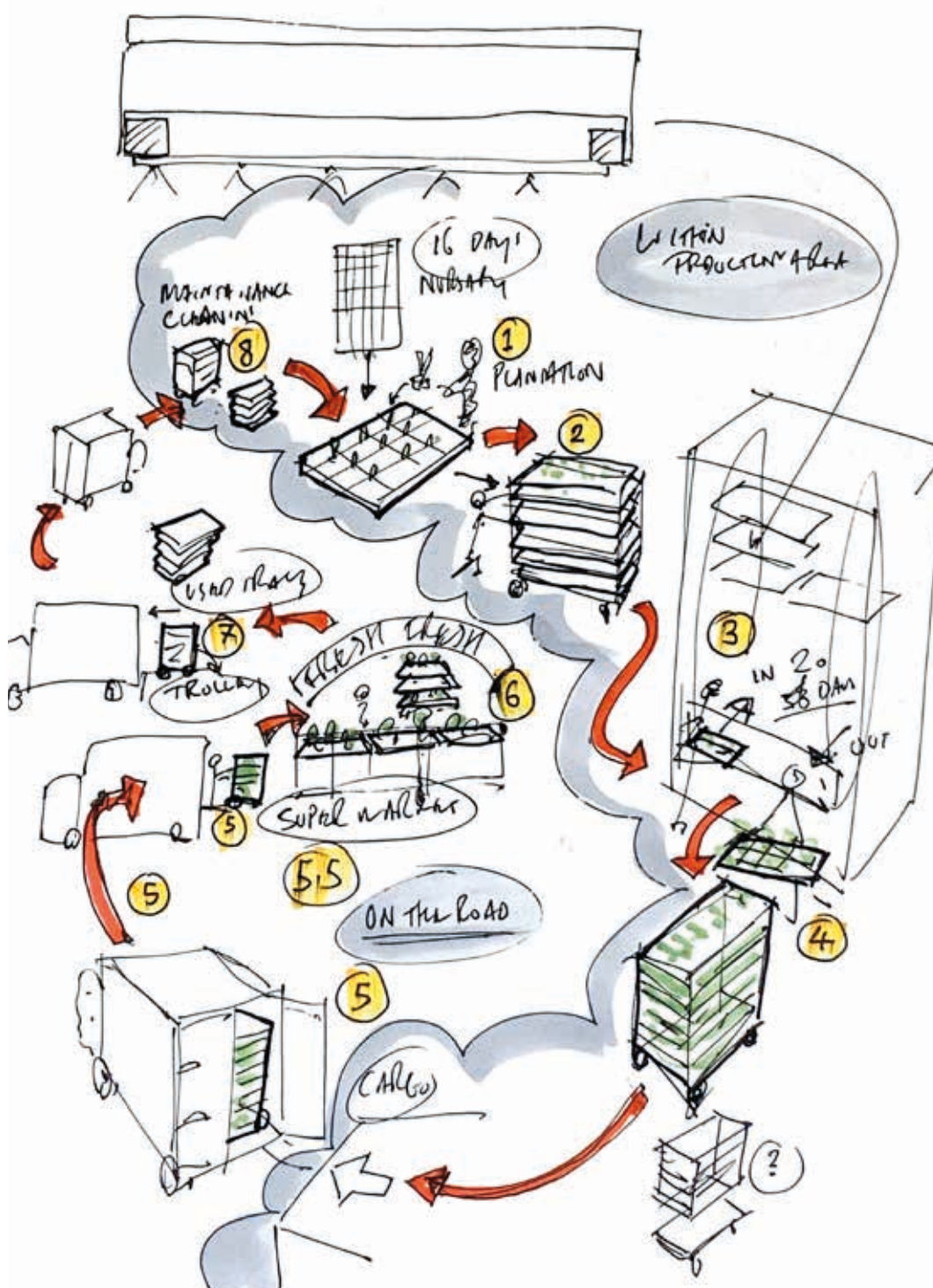
Figura 51. Descrição gráfica das várias etapas de uma micro-cadeia de abastecimento alimentar, em que a produção é realizada através da agricultura vertical urbana. Fonte: Autor.
