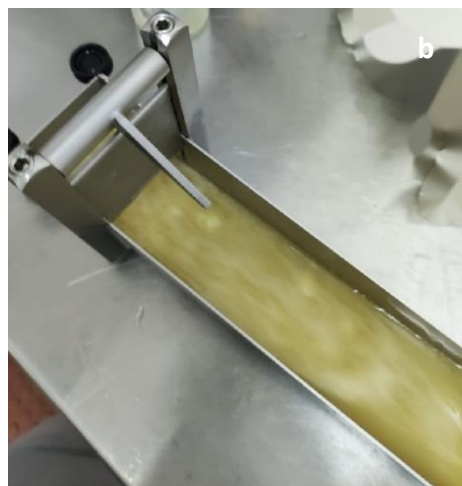
Fotografia 15 - Uso do consistômetro nas amostras para comparação da consistência. Antes de abrir a comporta (a); depois de abrir a comporta (b)
