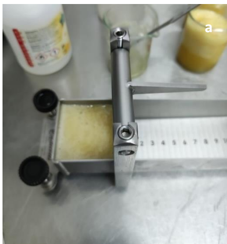
Fotografia 15 - Uso do consistômetro nas amostras para comparação da consistência. Antes de abrir a comporta (a); depois de abrir a comporta (b)
