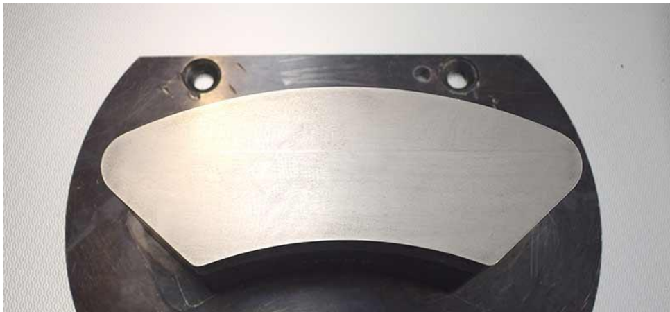
Figura 4.3 - Componente moldante, após o processo de limpeza e retificação de correção de altura.
