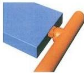
Figura 3.32 - Representação esquemática do sistema de alimentação por jito de ataque em lâmina (CENTIMFE, 2003).
