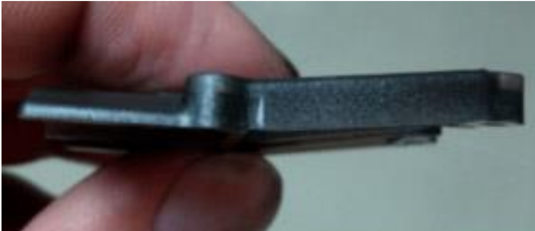
Figura 4.21 - Peça com problemas de empeno (Fit Tecnologia, 2021).
