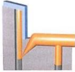
Figura 3.31 - Representação esquemática do sistema de alimentação de injeção nos extratores (CENTIMFE, 2003).
