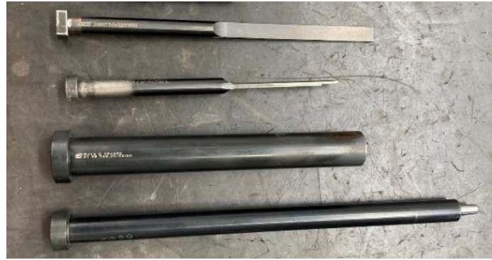
Figura 3.13 - Exemplo de vários extratores: Laminar, Rebaixado, Tubular, Rebaixado (de cima para a baixo, respetivamente).
