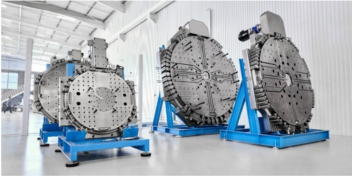
Figura 3.21 - Prato rotativo utilizado moldes bi-matéria da empresa Vangest (Vangest, 2019)
