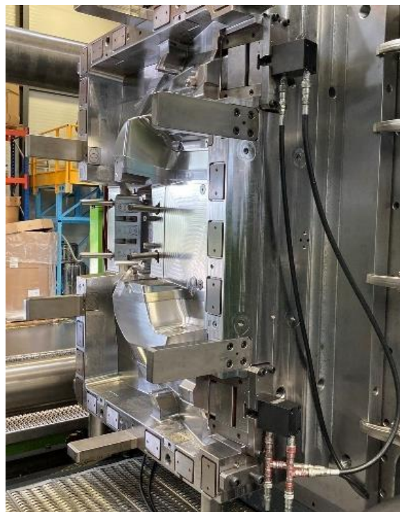
Figura 4.18 - Cavidade montada na máquina de injeção e limpa.
