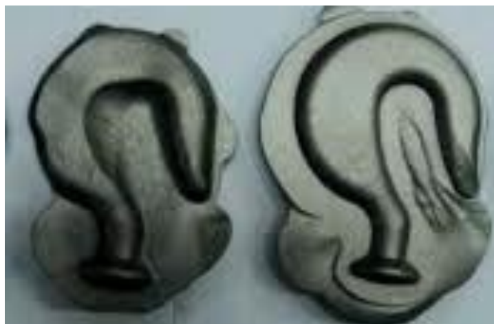
Figura 4.19 - Representação de uma peça com rebarba (Fit Tecnologia, 2021).
