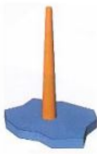
Figura 3.26 - Representação esquemática do sistema de alimentação por jito direto (CENTIMFE, 2003).
