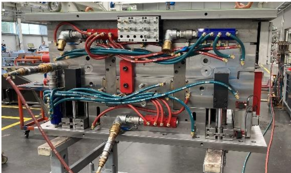
Figura 4.7 - Exemplificação da realização do teste refrigeração.
