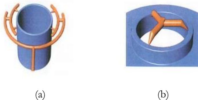
Figura 3.30 - Representação esquemática do sistema de alimentação por jito de ataque em anel (a) e ataque em diafragma (b) (CENTIMFE, 2003).
