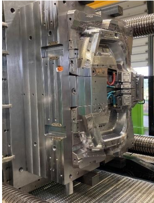
Figura 4.17 – Bucha montada na máquina de injeção e limpa.
