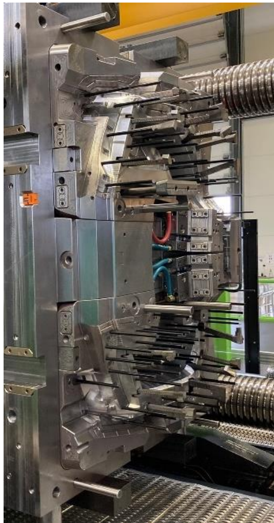
Figura 4.16 - Verificação dos movimentos dos extratores e balancés durante o teste de extração na máquina de injeção.
