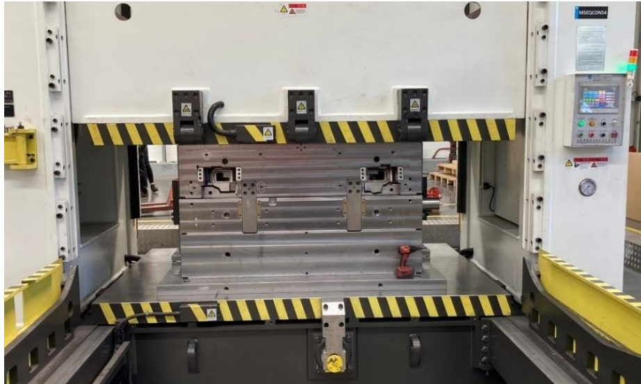
Figura 4.11 - Teste de compressão do molde ED21M5189.
