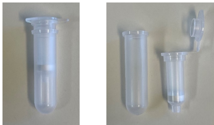
Figuras 10 e 11. Coluna QIAamp MinElute inserida num tubo coletor de 2 ml.
