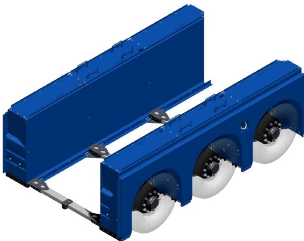
Figura 19 - Esquema dos eixos traseiros equipados com Suspensões Pneumáticas LV-O (Product Information, TRIDEC, 2023)
