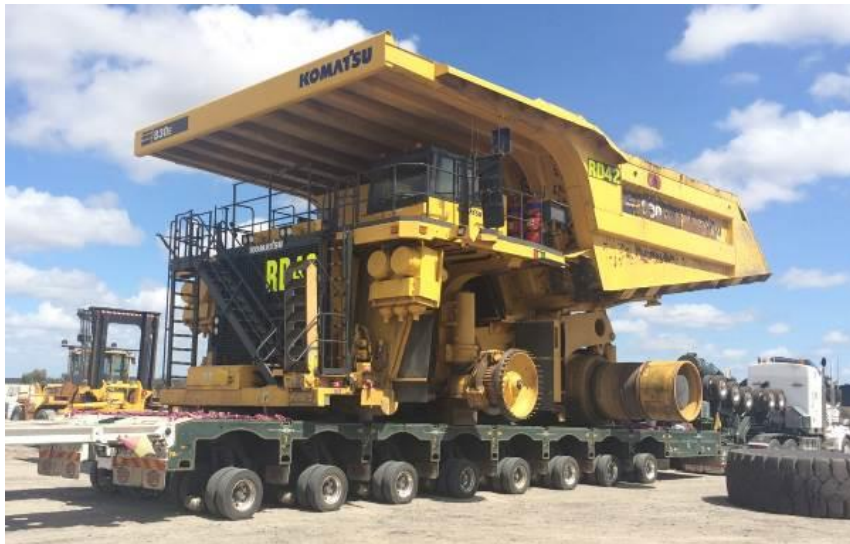
Figura 24 - Exemplo de um camião equipado com o Sistema de Suspensão Hidráulica TP-O (Product Information, TRIDEC, 2023)
