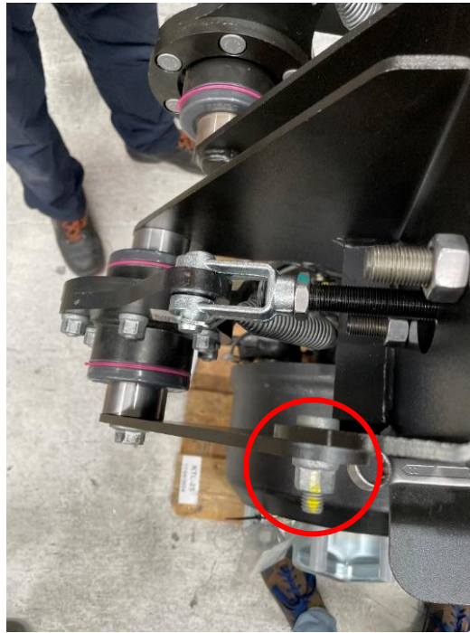
Figura 45 – Marcar os parafusos a amarelo depois de apertados
