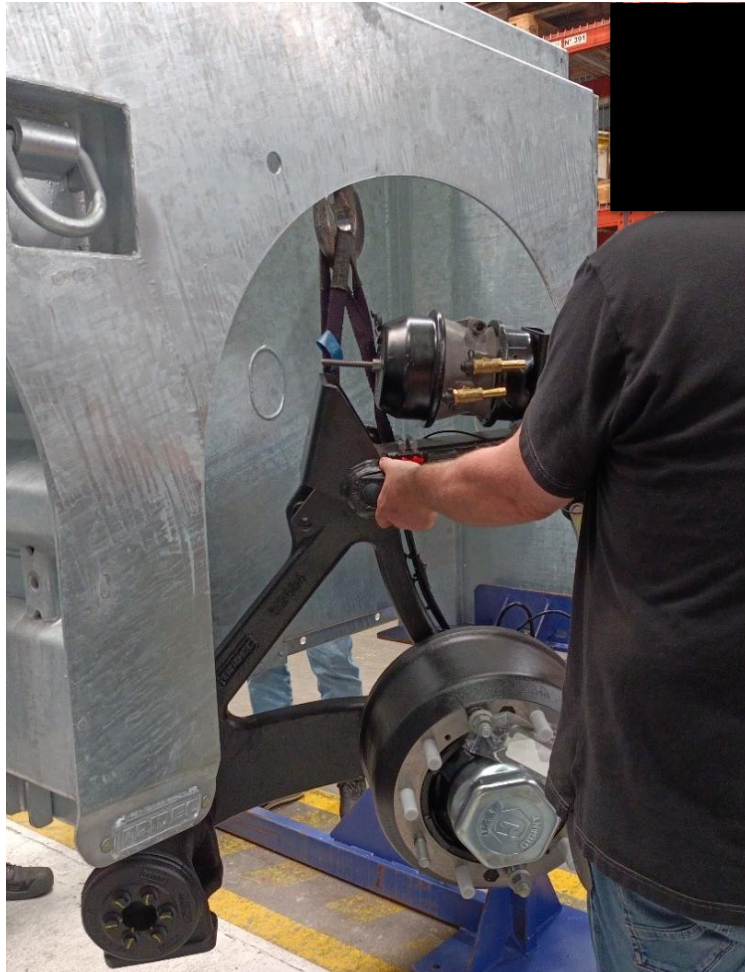
Figura 43 – Uso da grua para auxiliar no processo
