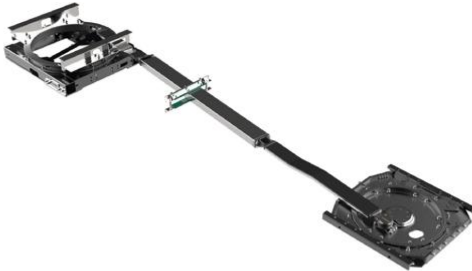
Figura 8 - Sistema Direcional Mecânico TD (Product Overview, TRIDEC, 2024)
