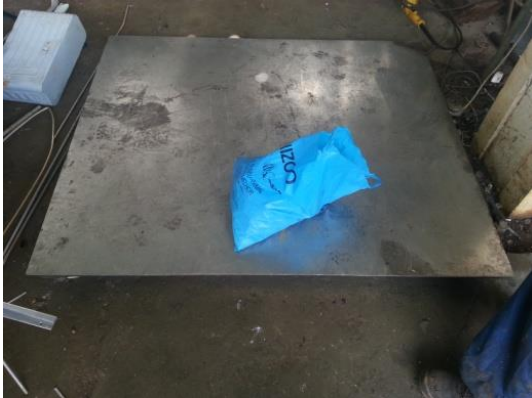
Figura 4 - Balança com precisão de 0,5Kg
