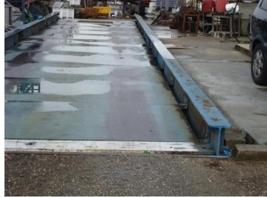
Figura 3 - Plataforma báscula com precisão de 20Kg
