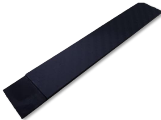
Figura 3.12 - Provete em PRFC com degrau de 2 para 1 mm.
