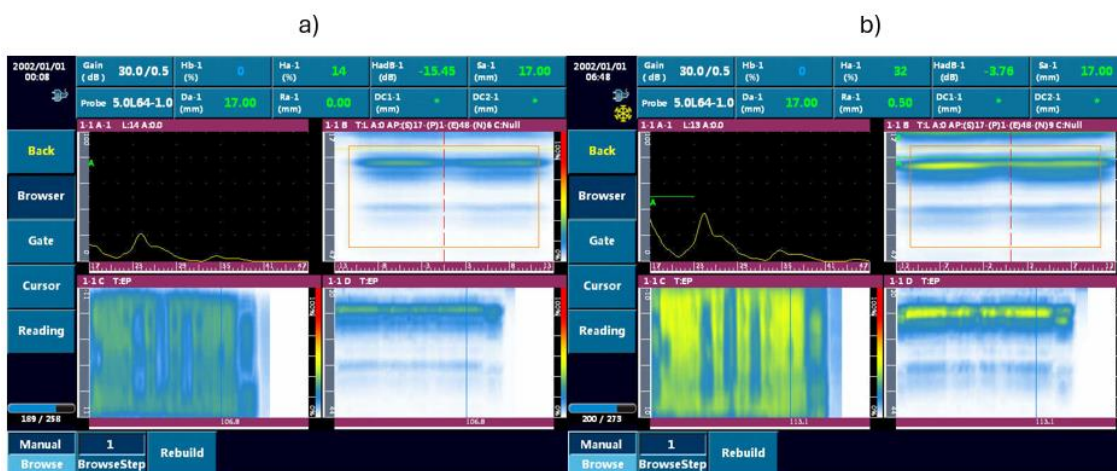
Figura 4.26 - Comparação entre leituras com abertura de 6 (a) e 9 (b) PZTs
