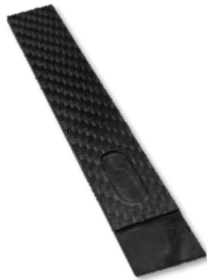
Figura 4.2 - Primeiro provete para testes preliminares de calibração
