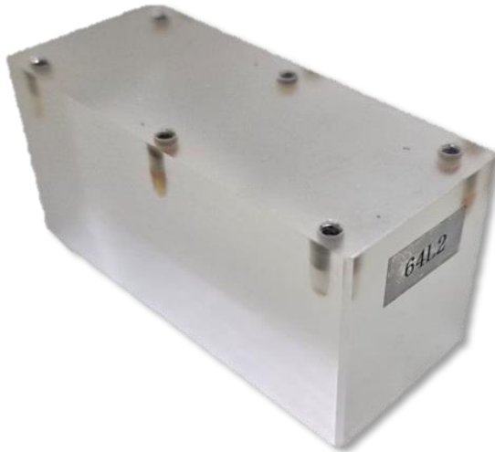
Figura 4.1 - Calço de 40mm para PAUT
