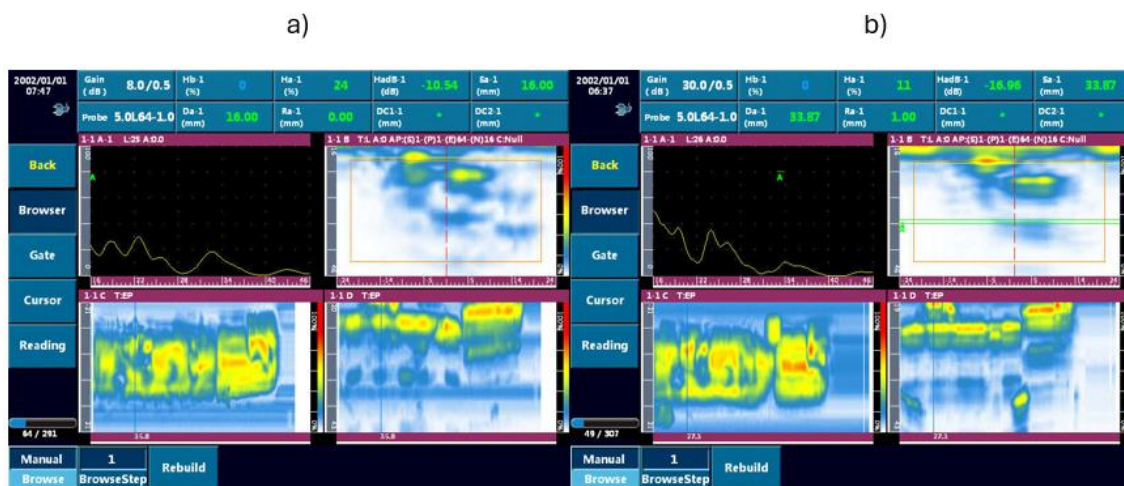
Figura 4.14 - Comparação de Leitura a 5MHz (a) e 10 MHz (b).
