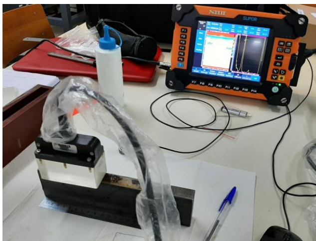
Figura 3.15, possui uma menor zona morta e um feixe mais concentrado. Isto é possível através do disparo coordenado e sincronizado dos elementos.
