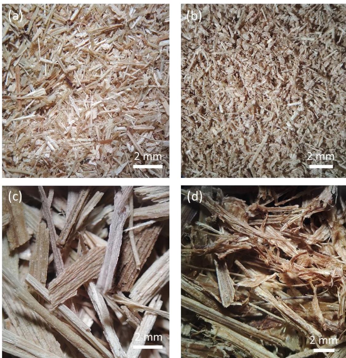
Figura 4.1 - Fibras de conteira: (a) de 0,5 mm antes do tratamento; (b) de 0,5 mm após o tratamento; (c) de 12 mm antes do tratamento; (d) de 12 mm após o tratamento.
