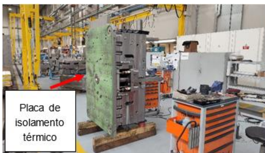
Figura 50 - Exemplo de colocação de placa de isolamento térmico na parte traseira das placas de encosto.
