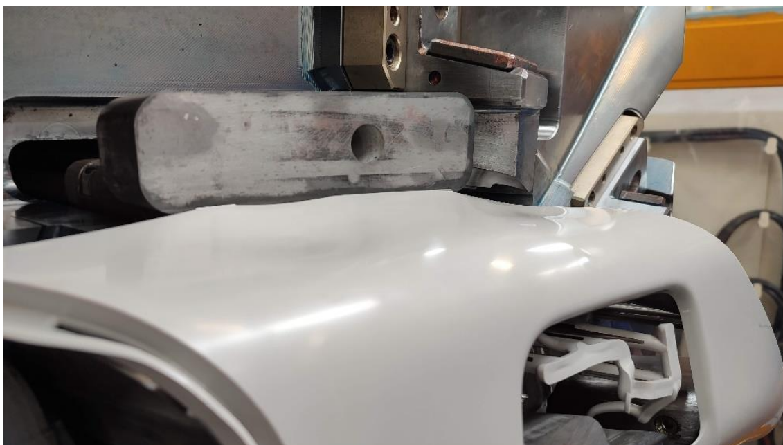
Figura 100 - Prisão da peça nos levantadores durante a desmoldagem, provocando deformações na peça.
