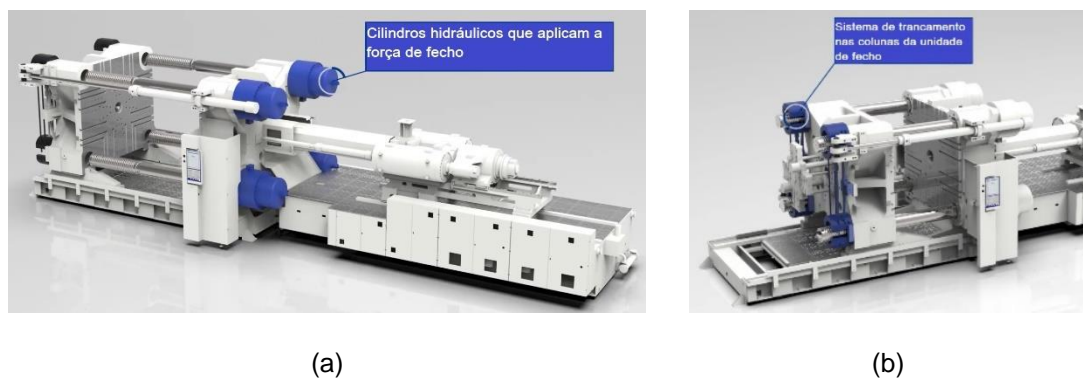
Figura 67 - Exemplo de uma unidade de fecho hidráulico ( Haitian Group, 2022 ): (a) – cilindros hidráulicos que garantem a força de fecho; (b) – sistema de trancamento da unidade de fecho.
