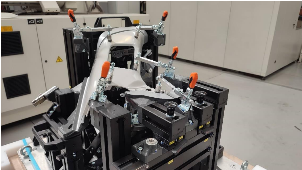
Figura 103 - Medição das peças poliméricas no gabarit fornecido para o molde em estudo.
