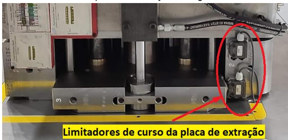
Figura 59 - Exemplo de aplicação de limitadores de curso na placa de extração.
