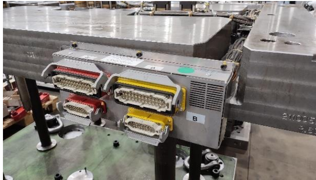
Figura 62 - Exemplo de caixa de ligações elétricas de um molde.
