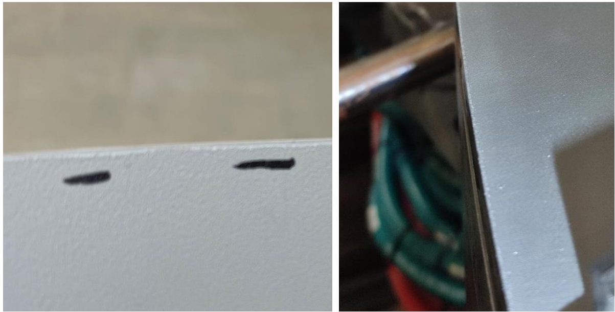
Figura 120 - Textura da danificada nas extremidades das peças poliméricas: (a) – região da textura danificada; (b) – vestígios de material polimérico no aço da cavidade.
