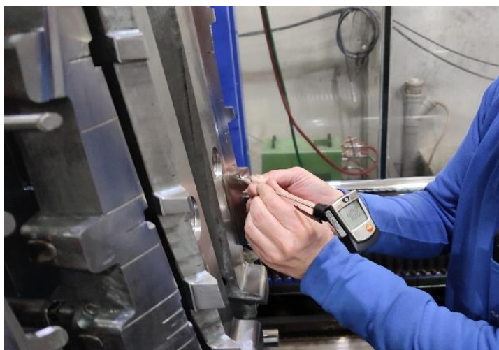
Figura 43 - Medição da temperatura das superfícies do molde com um termómetro de contacto.
