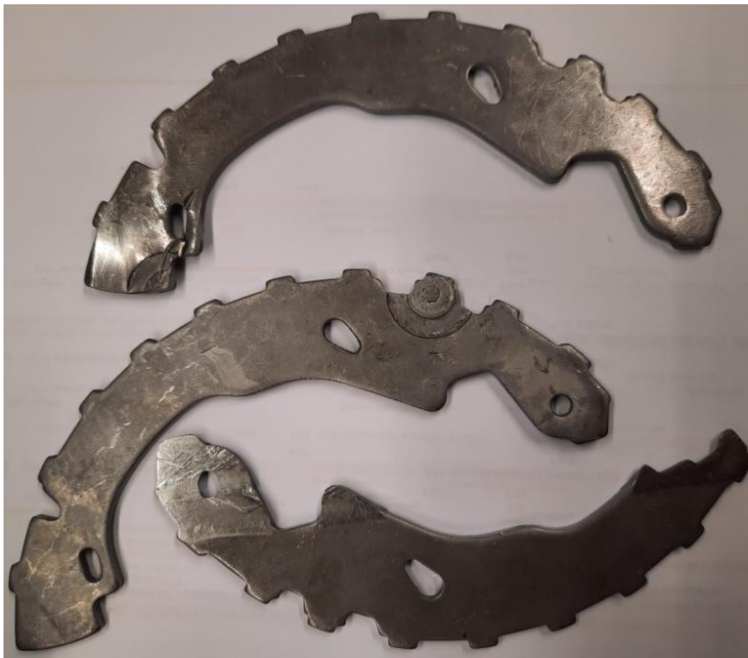
Figura 29: Peças com defeitos de falhas na extração e falhas na alimentação da banda.
