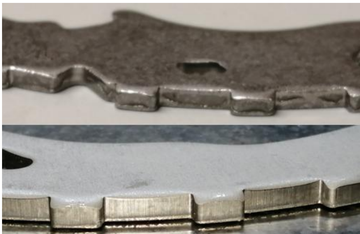
Figura 33: Fotos comparativas de almas cortadas por fineblanking antes e depois do raio na zona de corte da matriz.
