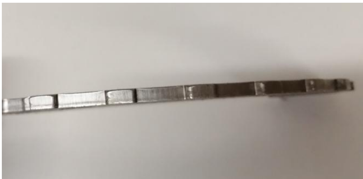
Figura 31: Foto da face cortada após a quebra das zonas de corte na matriz.
