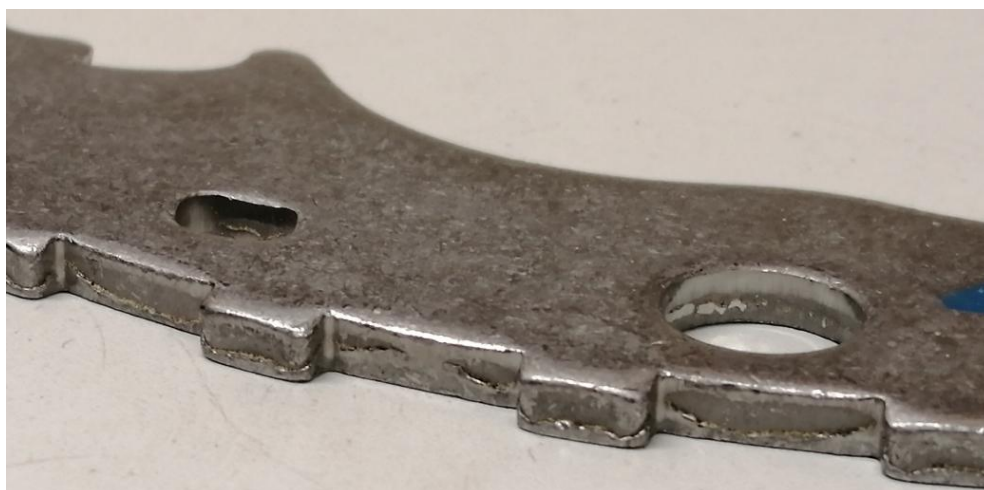
Figura 28: Alma fineblanking com falhas na face cortada.
