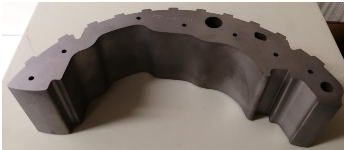
Figura 30: Punção de corte com correção do tratamento e polimento nas laterais.
