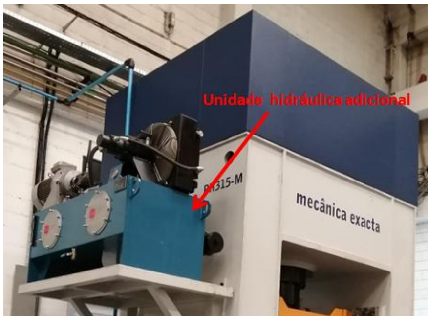
Figura 21: Unidade hidráulica adicional.
