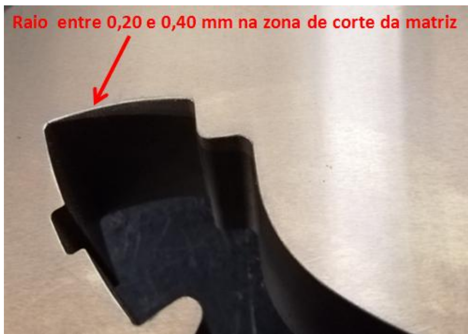
Figura 32: Foto da matriz com raio na zona de corte.
