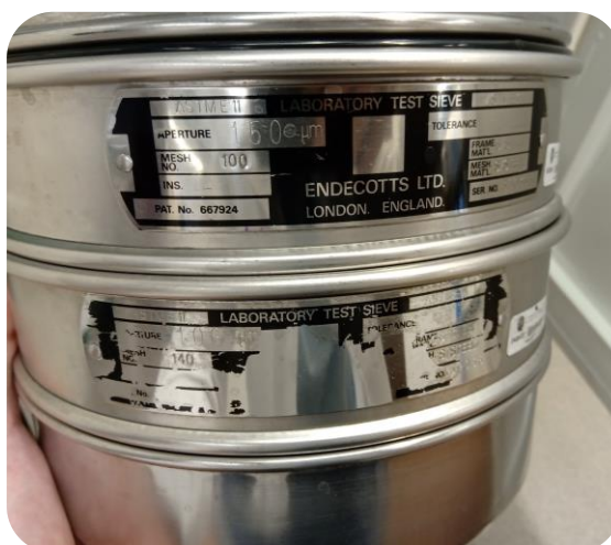
Figura 10 - Peneiros moleculares utilizados para fracionamento granulométrico dos carvões ativados.
