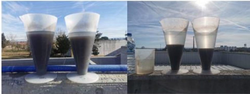
Figura 3 – Cones Imhoff no início da análise do V30 (à esquerda), Cones Imhoff no final da análise do V30 (à direita)
