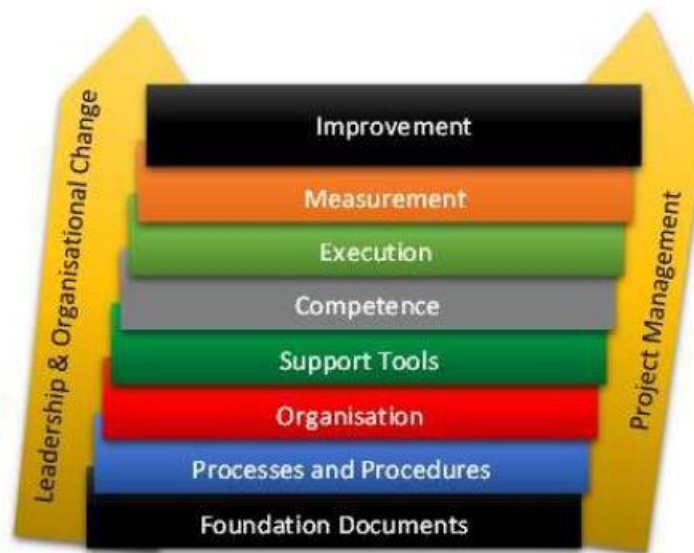
Figura 5 - Sequência lógica da implementação da ISO 55001, adaptado de (Pais et al., 2019)
