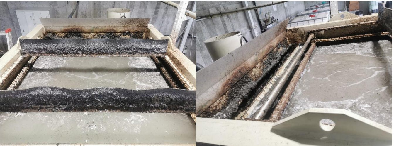
Figura 14 - Flotador (VAMEF) e respectivos raspadores de lamas
