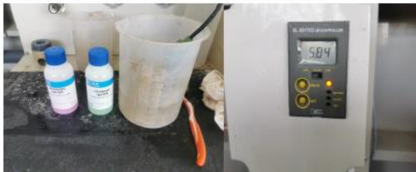
Figura 2 – Sonda de pH mergulhada em água para limpeza e soluções de calibração (à esquerda) e controlador conectado à sonda de pH onde é efectuada a calibração do equipamento (à direita)
