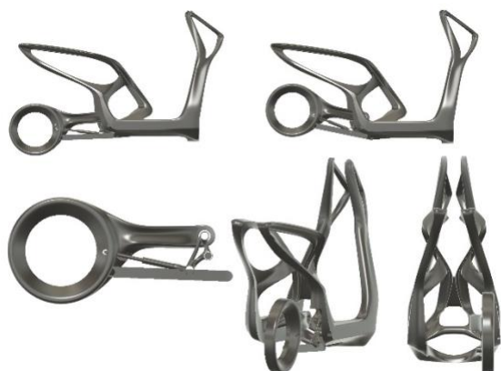
Fig. 72 – Criação de um chassi não rigoroso com sistema de amortecimento funcional na escora para a primeira proposta de scooter.
