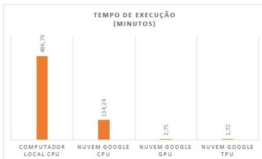
Figura 33 Benchmark usado para avaliar o desempenho de uma LSTM em diferentes tipos de hardware
