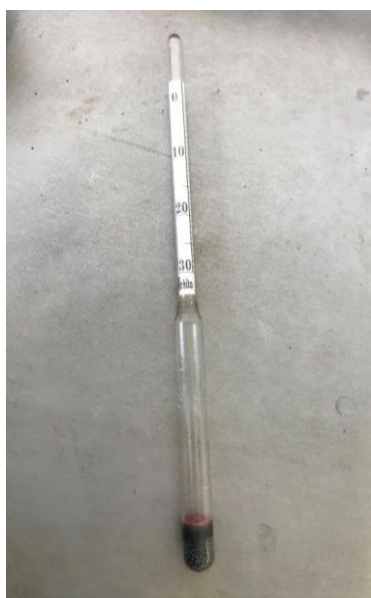
Figura 23 - Densímetro de Baumé (Cofisa2)
