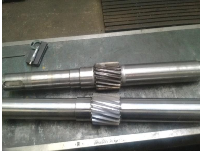
Figura 75 – Veio carreto original danificado e o novo pinhão corrigido
