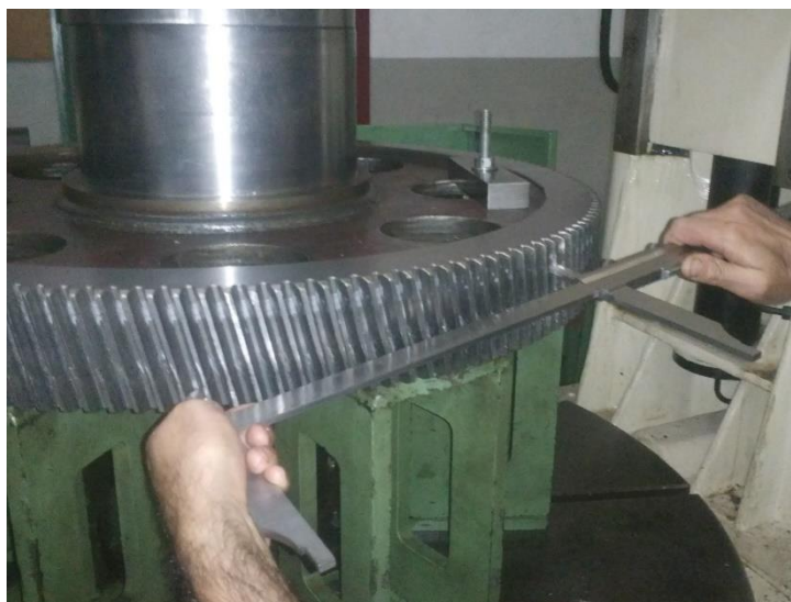
Figura 68 – Medição da distância Z_m entre “k” dentes na Roda
