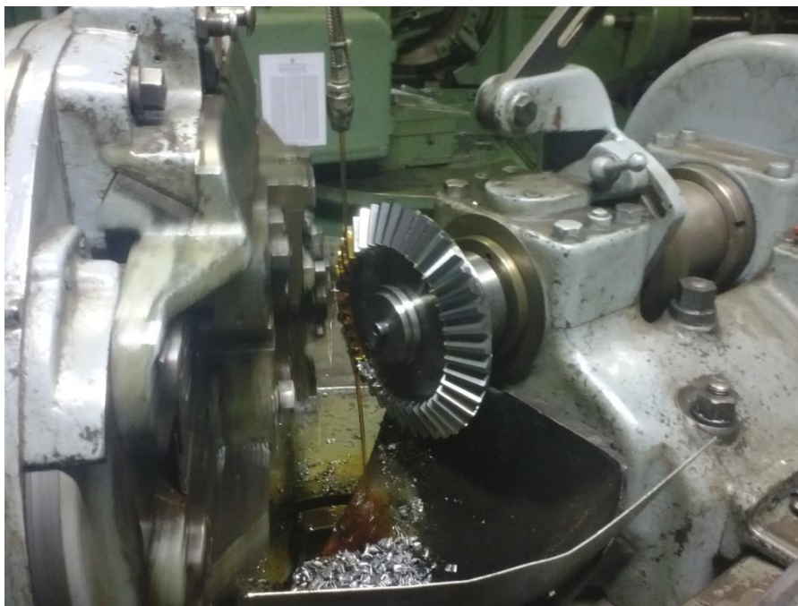
Figura 12 – Gleason 12, engrenagens cónicas de dentado reto
