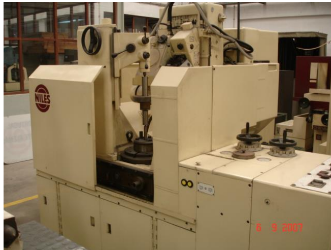
Figura 17 - Retificadora de flancos em engrenagens de dentes retos e helicoidais
