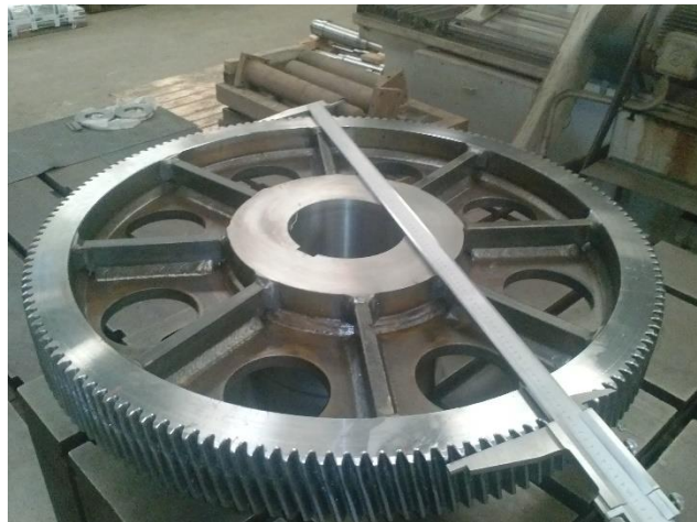
Figura 64 – Medição do diâmetro externo da Roda
