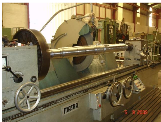
Figura 7 – retificação de Veio com 2.5m
