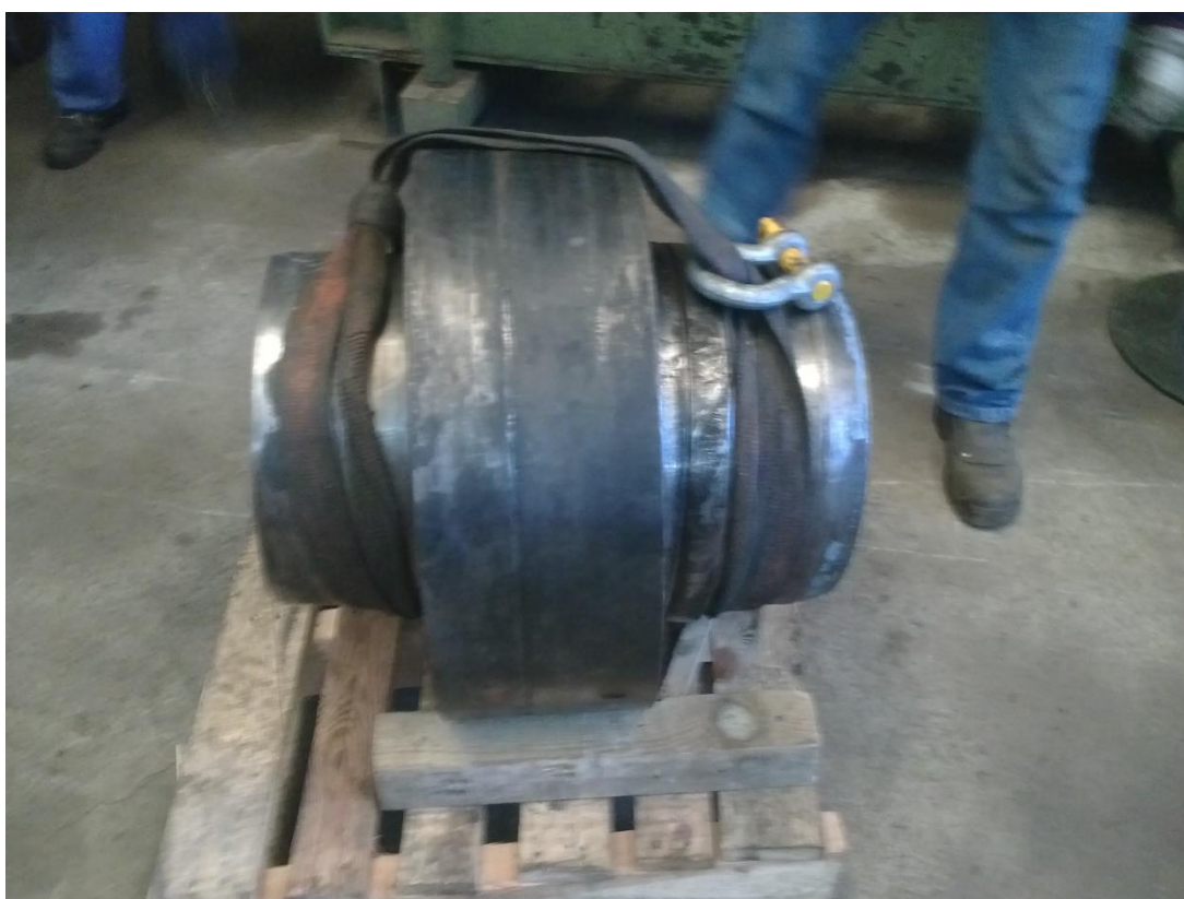
Figura 84 – Desmontagem da Rótula danificada da ponte móvel do porto de Leixões e fabrico de novo veio
