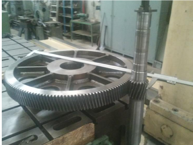
Figura 66 – Medição do entre eixos de funcionamento das Engrenagens
