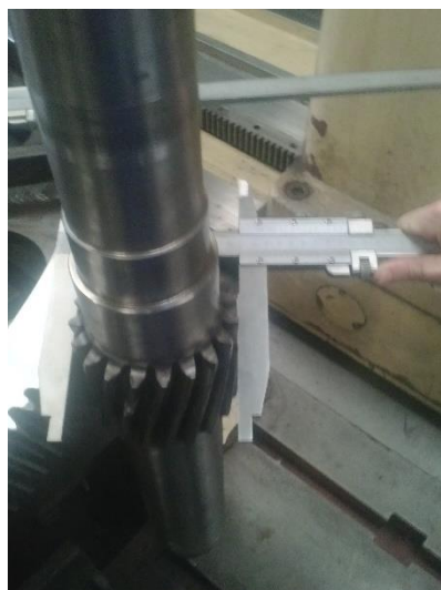
Figura 65 – Medição do Diametro externo do Pinhão
