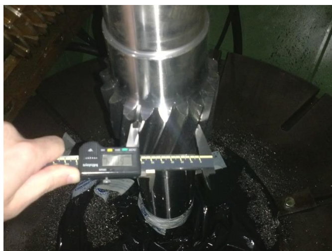
Figura 74 – Controlo da medida Z_m do novo pinhão
