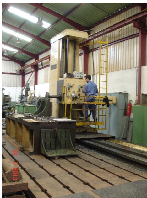
Figura 6 – Facejamento de peças na mandriladora Wotan
