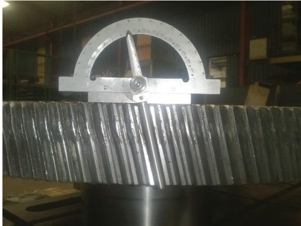
Figura 63 – Leitura do Angulo de Hélice da Roda através de uma suta
