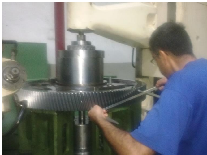
Figura 72 – Medição da distância Z_m após retificação da roda
