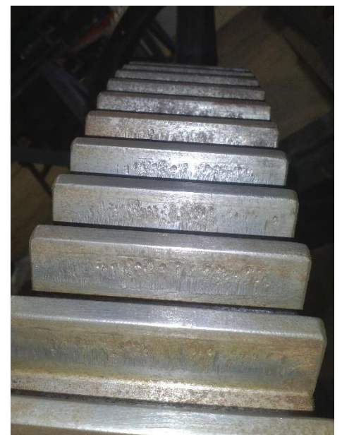
Figura 88 – Recondicionamento das engrenagens da Barragem Hidroelétrica de Belver, Retificação das Rodas que apresentavam desgaste e fabrico de novos Pinhões corrigidos
