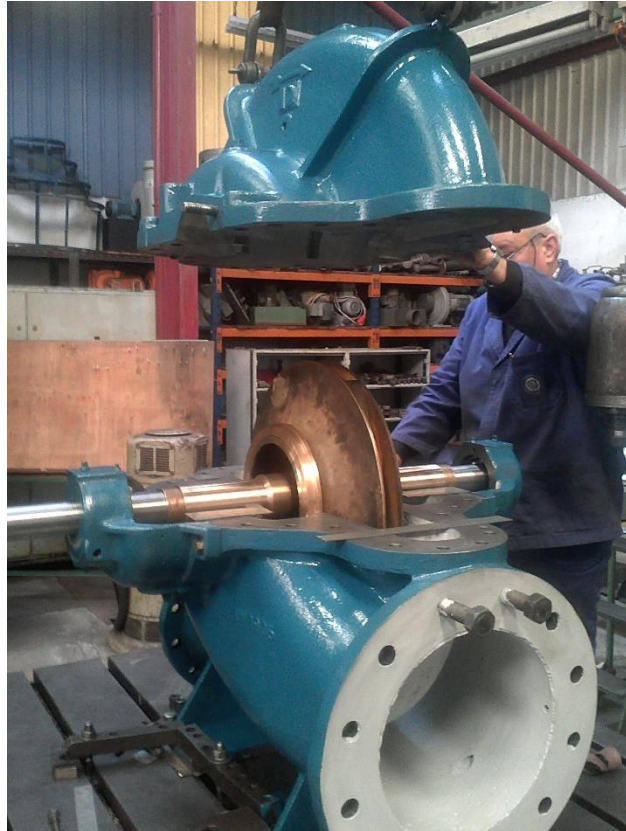
Figura 8 – Reparação de Bomba de Água
