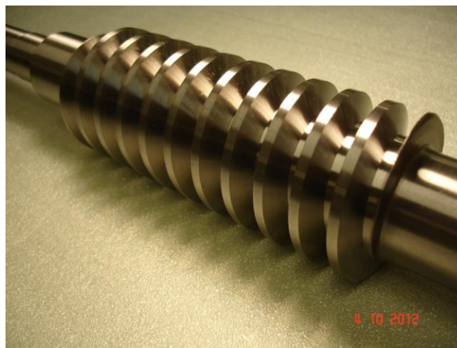
Figura 18 – Sem Fim com o dentado retificado
