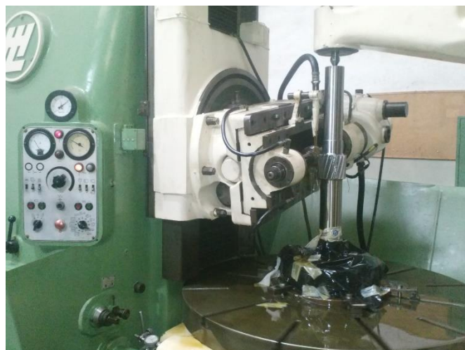
Figura 73 – Fresagem do novo pinhão corrigido
