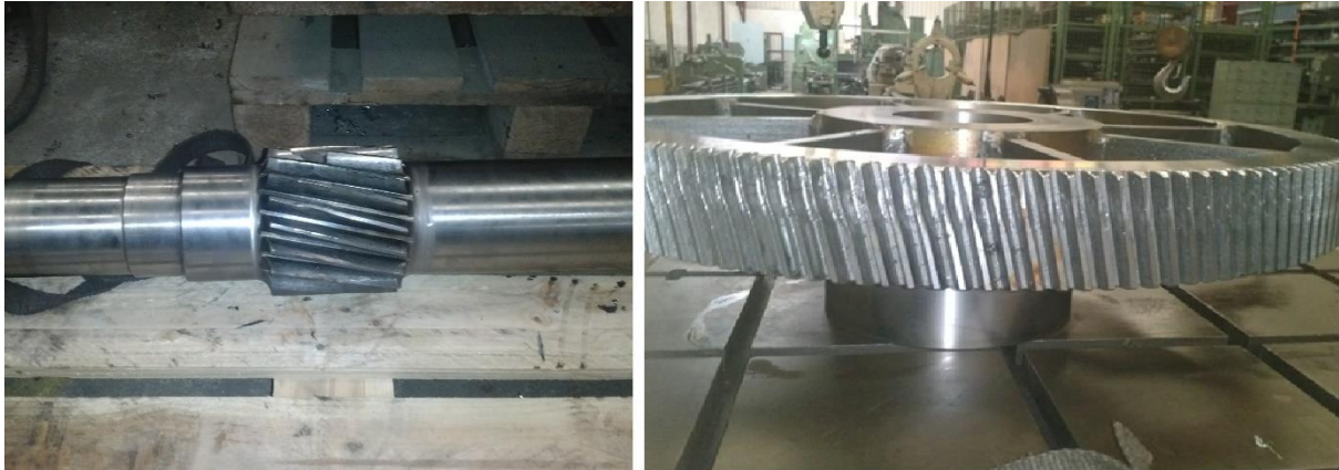
Figura 62- Conjunto de engrenagens danificadas para retificar
