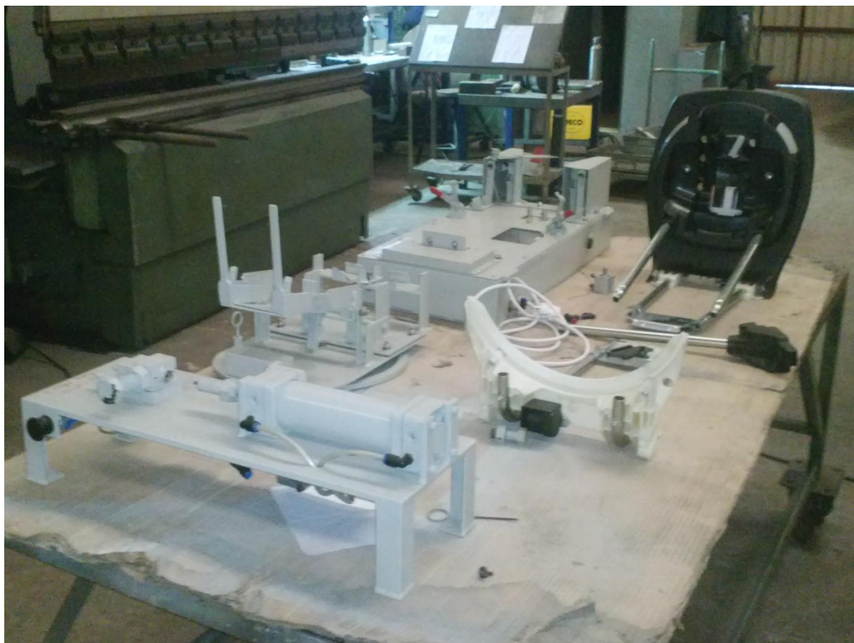
Figura 89 – Projeto e fabrico de Gabarits com automação, pneumática e acionamentos mecânicos para a linha de produção da Baby Confort
