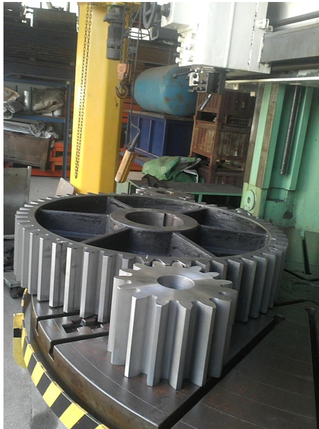
Figura 20 – Conjunto de engrenagens M18 retificadas após gripagem
