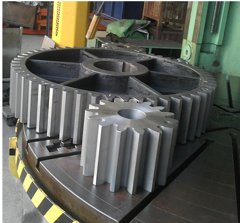
Figura 59 – Retificação de Engrenagens Módulo 18
