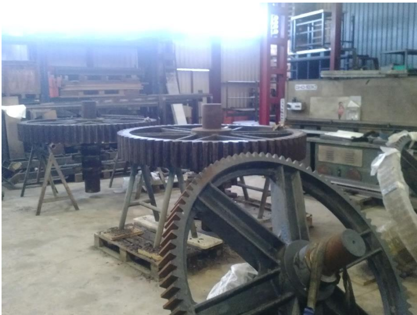
Figura 88 – Recondicionamento das engrenagens da Barragem Hidroelétrica de Belver, Retificação das Rodas que apresentavam desgaste e fabrico de novos Pinhões corrigidos
