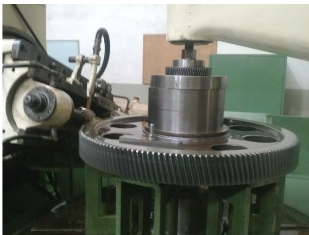
Figura 71 – Retificação do dentado da roda
