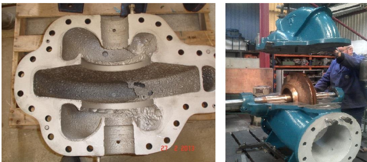
Figura 83 – Reparação de Bomba de água da Petrolgal
