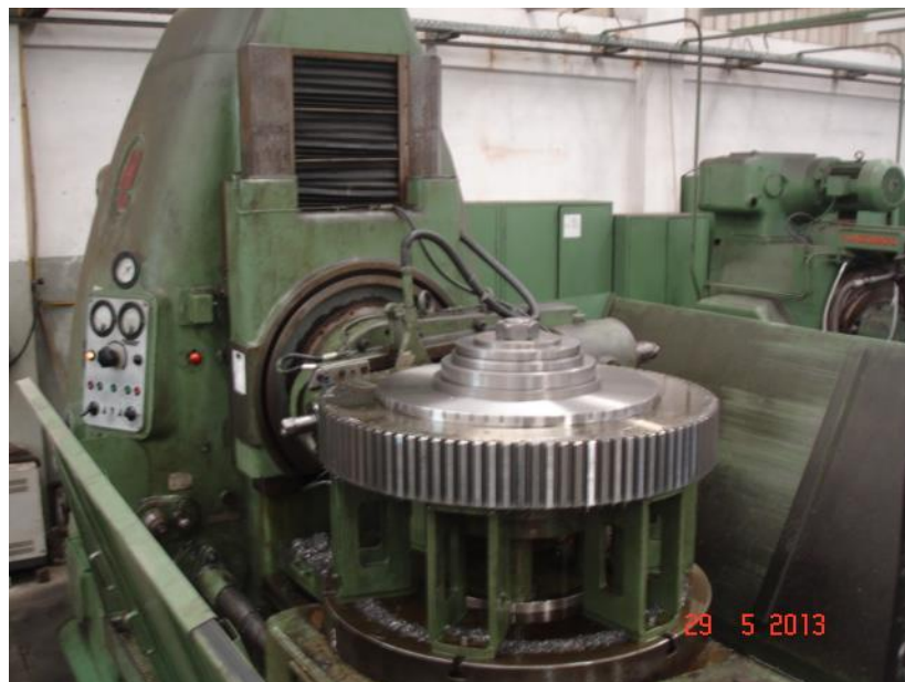
Figura 10 – Fresagem de dentado M10 diâmetro 1100mm
