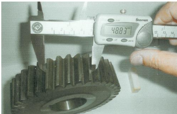
Figura 56 – Medição em Z_m dentes em dentado helicoidal
