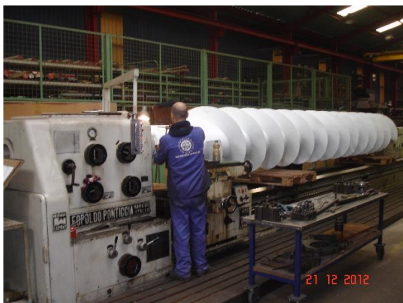
Figura 5 – Reparação de Sem Fim com 8 metros
