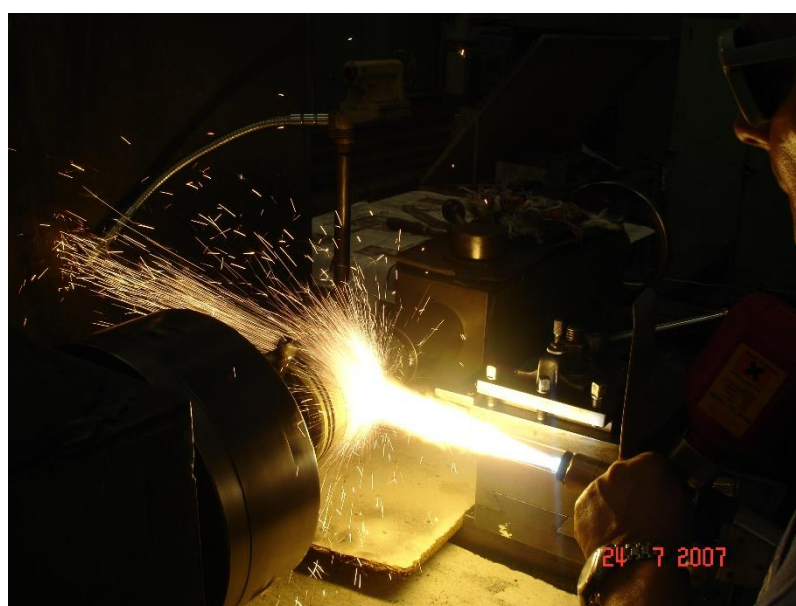
Figura 3 – Projeção de ligas para enchimento de veio
