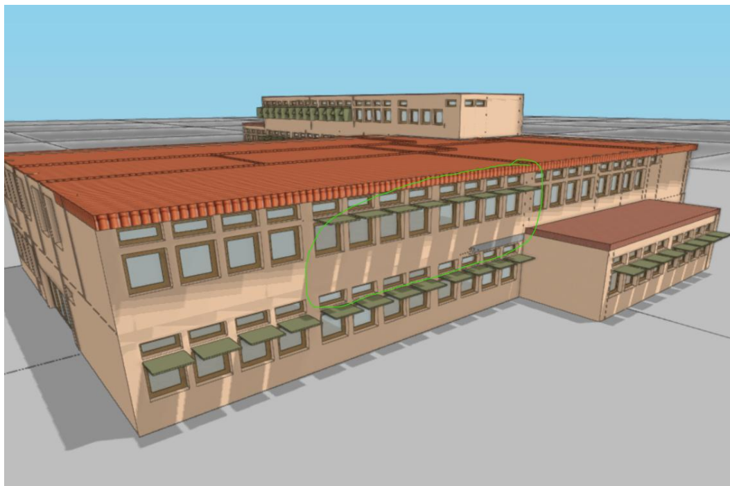
Figura 6.9- Efeito do sombreamento das palas solares no edifício.
