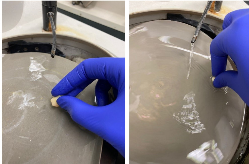
Figura 11- Simulação da camada de smear layer através do polimento da superfície dentária com a polidora (LaboPol-4, Struers, Dinamarca)
