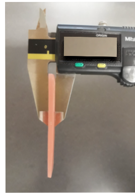
Figura 11 - Micrômetro digital de precisão \pm 0,01 mm (Digimatic caliper, Mitutoyo, Tokyo, Japan)
