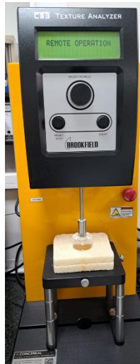
Figura 40. Brookfield- CT3 Texture Analyzer. Equipamento a realizar medição da textura a uma amostra de pão.
