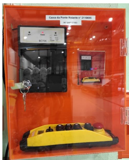
Figura 4.2:6 - Implementação da caixa para o comando e carregador da ponte rolante.
