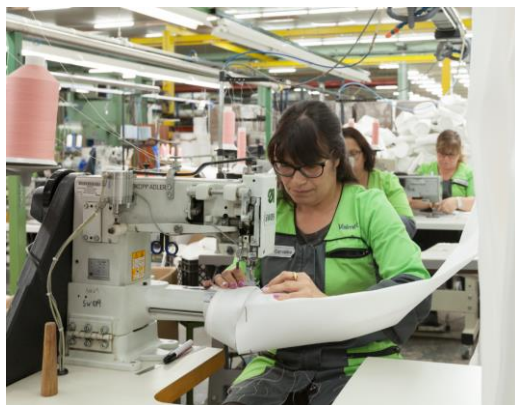
Figura 3.3:17 - Aplicação de reforços nas mangas de filtro (esquerda) e aplicação de fundos nas mangas de filtro (direita). (Valmet Corporation, 2019)
