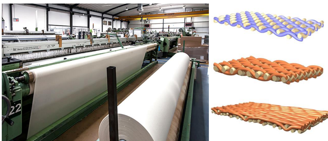
Figura 3.3:9 - Exemplo de um tear em funcionamento (esquerda) e representação de três tipos de debuxos diferentes, tafetá, sarja e cetim, (direita).
