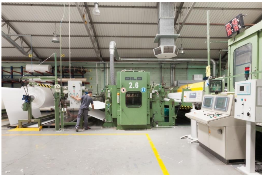
Figura 3.3:12 – Linha de agulhagem Thibeu 1, composta máquina de agulhar (Dilo 2.6).
