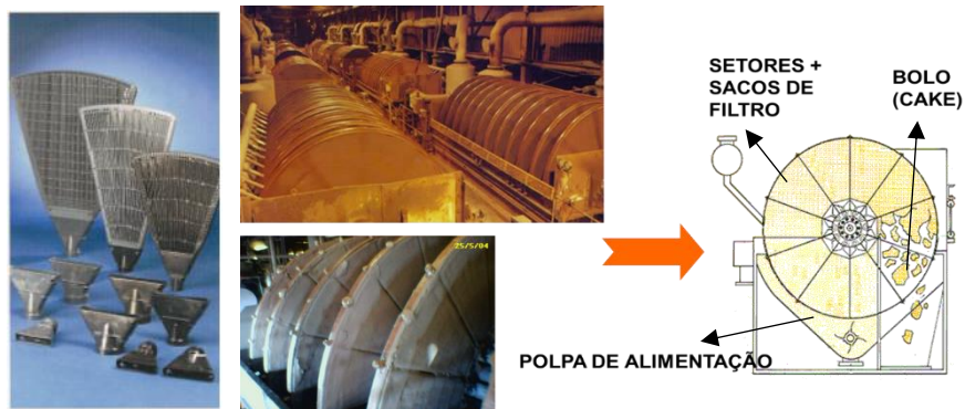
Figura 3.2:3 - Diversos tipos de tipo de discos (esquerda), filtros de disco a vácuo (centro) e o modo de funcionamento (direita).
