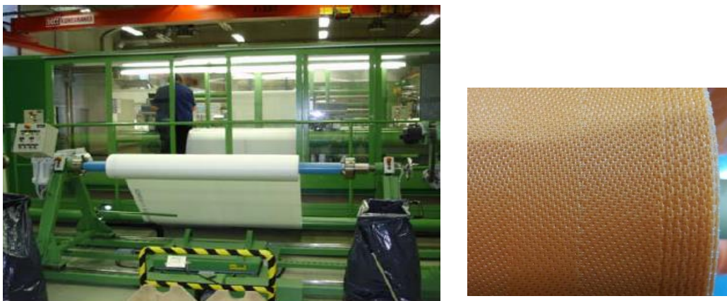
Figura 3.3:18 - Máquina para tratamento ultrassónico (esquerda) e exemplo de acabamento com tratamento ultrassónico (direita).
