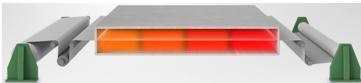
Figura 3.3:14 - Imagem demonstrativa de uma máquina de termofixação por ar quente. (Vídeo institucional do processo produtivo)
