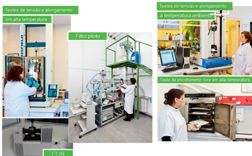
Figura 3.2:16 - Alguns exemplos de medições que são realizadas aos tecidos filtrantes em laboratório. (Valmet Corporation, 2019)
