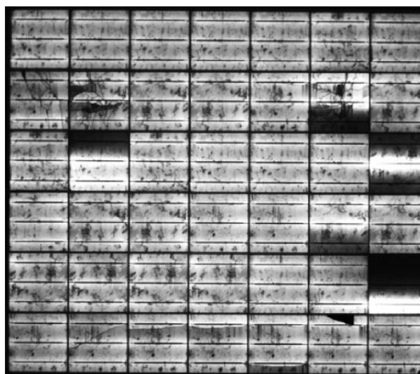
Figura 54: Eletroluminescência - barramentos de interconexão partidos [15]
