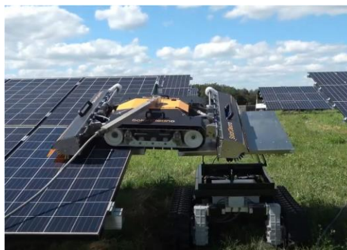
Figura 36: Robô de Limpeza Amovível
