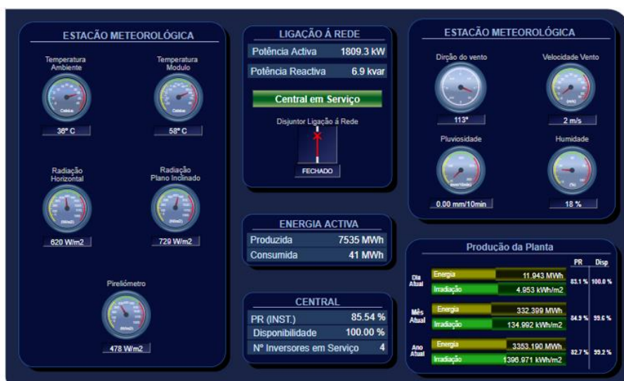
Figura 49: Sistema SCADA de monitorização - parques fotovoltaicos
