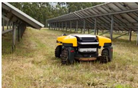
Figura 39: Corte de vegetação com desmatadora pilotada à distância
