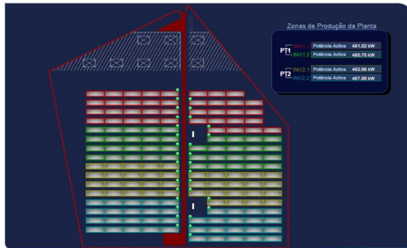
Figura 50: Monitorização de um parque fotovoltaico - planta geral
