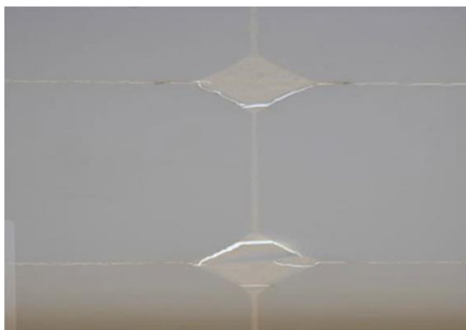
Figura 64: Folha traseira com fissuras após exposição ao ar livre [15]
