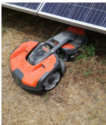
Figura 38: Corte de vegetação com recurso a robô
