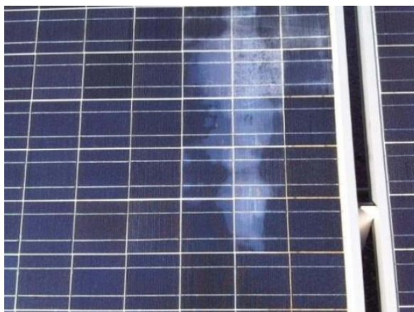
Figura 57: Delaminação sobre a CJ do encapsulante do vidro frontal [15]
