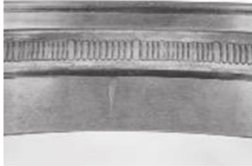
Figura 21: Pista de Rolamento - Descarga Atmosférica [7]
