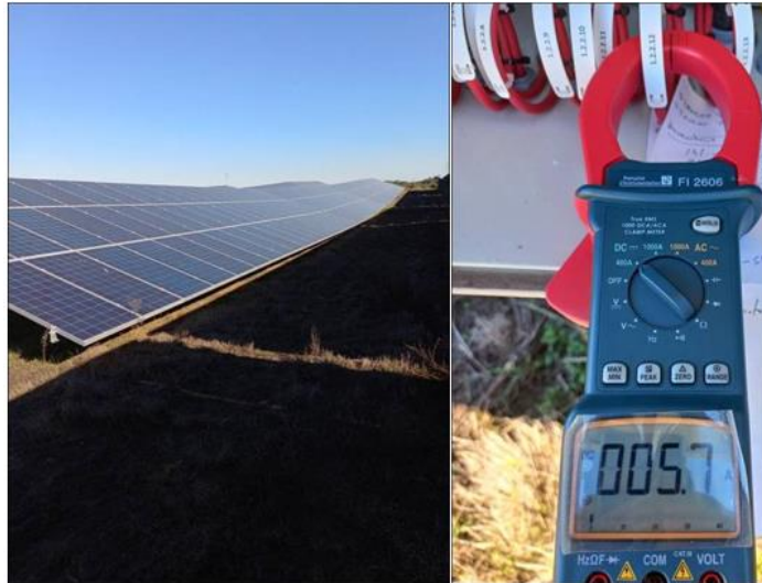
Figura 110: String indicada na Figura 108, mas sem o impacto da sombra (5,7 A)
