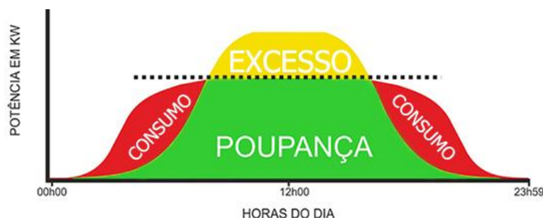
Figura 5.17 – Esquema produção diária de energia – Sistema Fotovoltaico.
