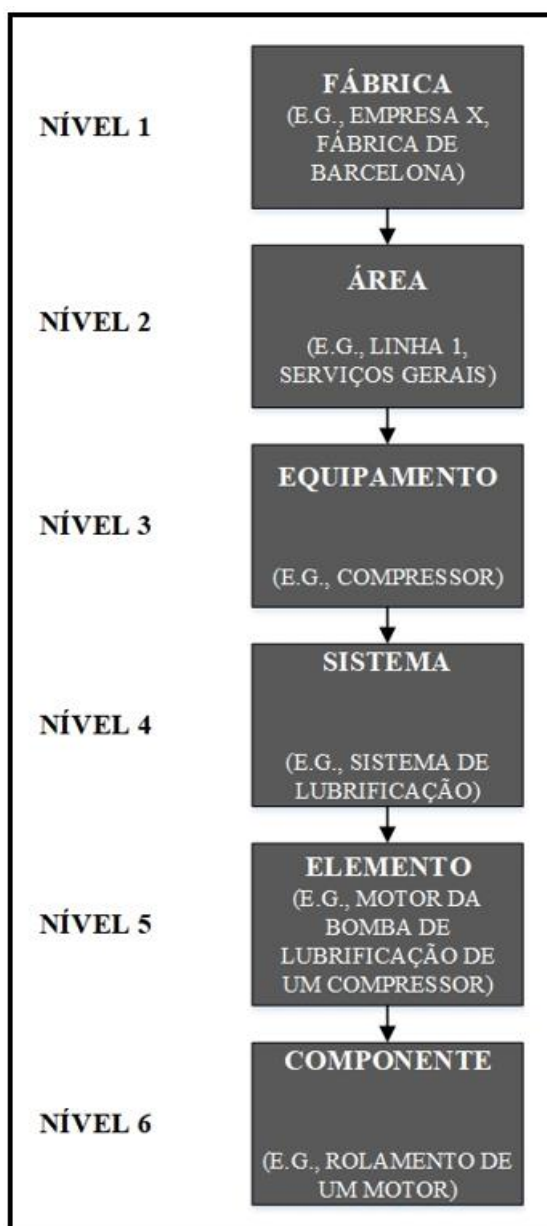
Figura An.1: Níveis para estruturar uma lista de equipamentos em forma de árvore e com hierarquia definida, adaptado (Garrido, 2003).
