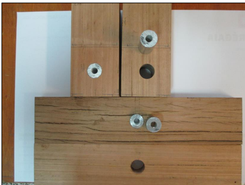
Figura 69 – Peça de pinho com reparação em casquilho de alumínio;
