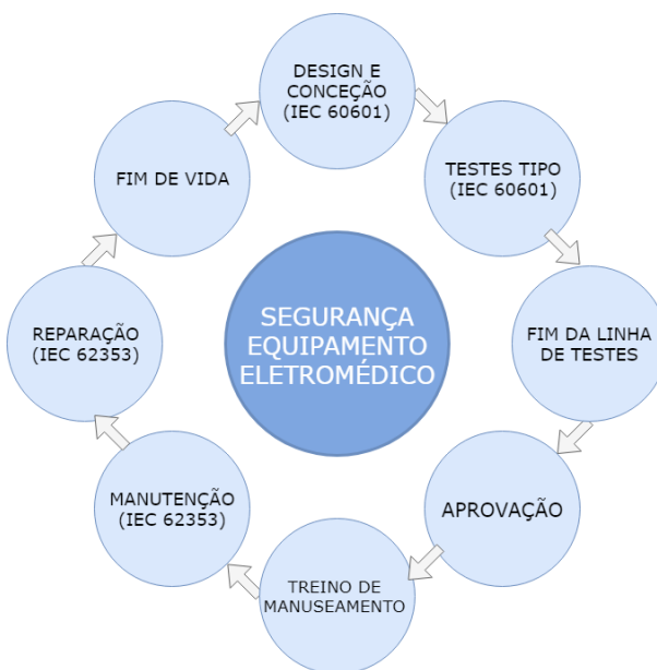
Figura 2.8: Ciclo de vida de um equipamento eletromédico perante as normas IEC e a manutenção 10 .
