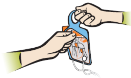
Figura 3.9: Como aplicar as pás descartáveis num equipamento DAE 25 .
