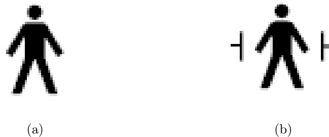
Figura 2.4: Símbolos contra choque elétrico categoria B; (a) Grau de proteção categoria B; (b) Grau de proteção categoria B e uso conjunto com Desfibrilhador 6 .
