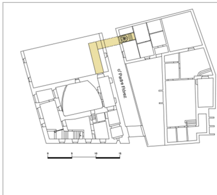
Fig. 77 Construcción de pasadizo
