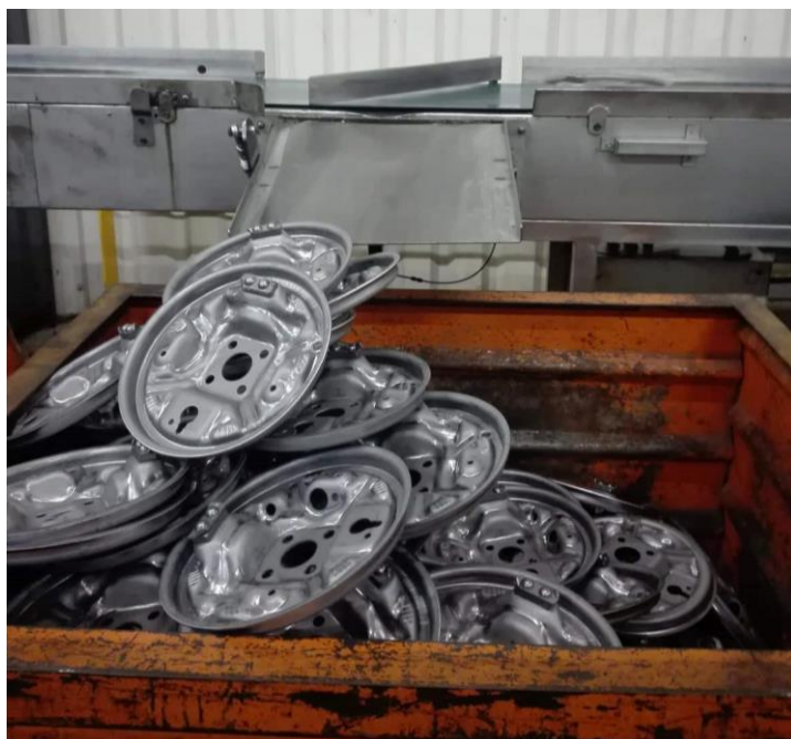
Figura 36 - Encravamento de pratos na rampa
