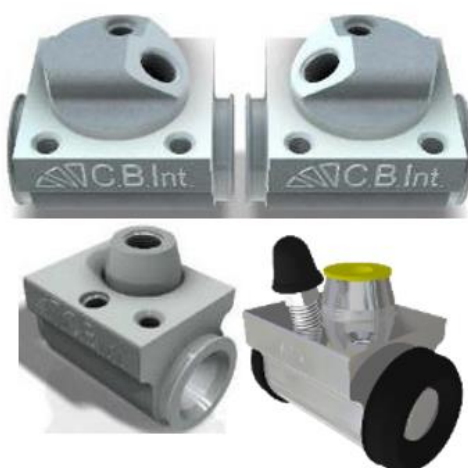
Figura 7 - Exemplo de maquinação e montagem dos cilindros
