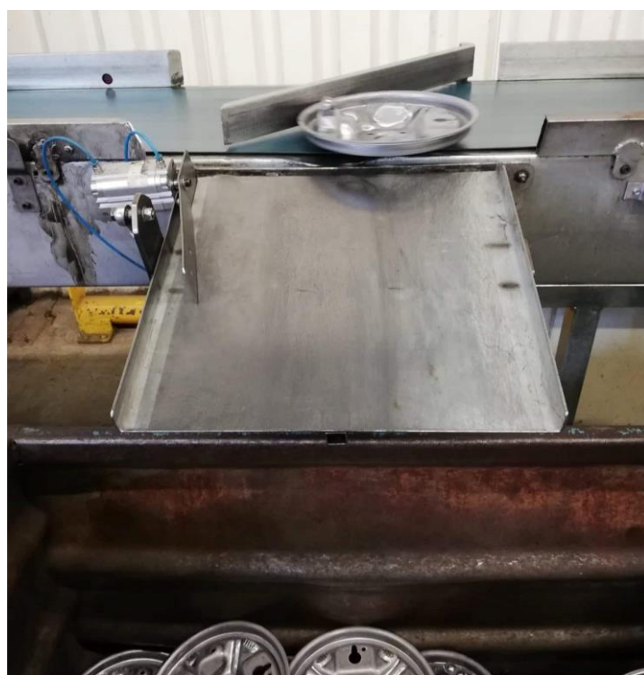
Figura 37 - Novo sistema com um cilindro pneumático nas extremidades
