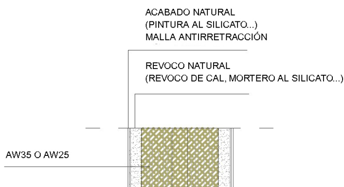
Figura 89. Sección Muro Alfawall (Bala-Box, 2021).
