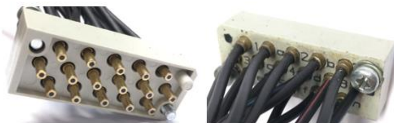
Figura 35 – Fotografia de Encaixe e núcleos da fibra ótica (Autor: Eduardo Ribeiro, 17/10/2020)
