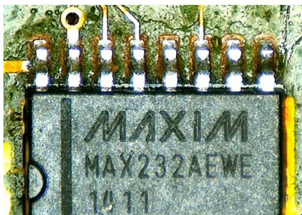
Figura 45 – Fotografia de soldadura adequada para SMD (ampliação de 50x)
