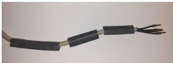
Figura 7 – Manga termo retrátil cortada e no cabo
