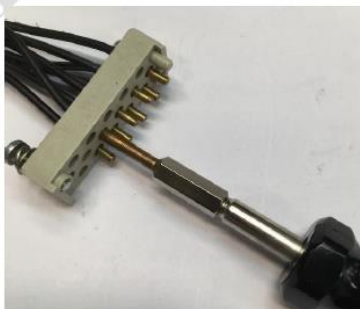
Figura 6 –Remoção dos pinos
