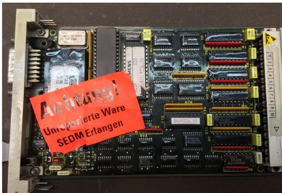
Figura 48 – Etiqueta de Equipamento sem reparação
