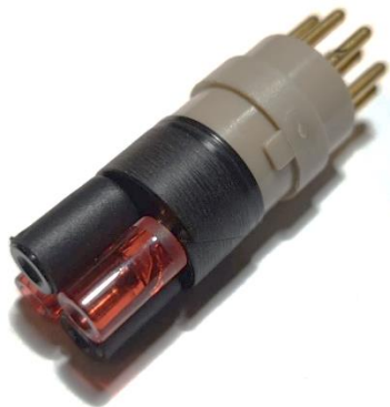
Figura 37 – Fotografia do conector interno da ficha do lado da Gate-Unit (Autor: Eduardo Ribeiro, 17/10/2020)
