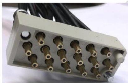
Figura 5 – Encaixe de plástico dos cabos de fibra ótica
