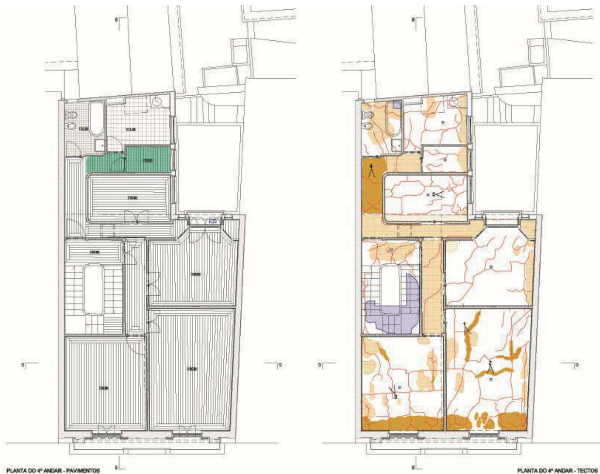
23 | Planta do Piso 4 | Patologias nos tetos e pavimentos;
