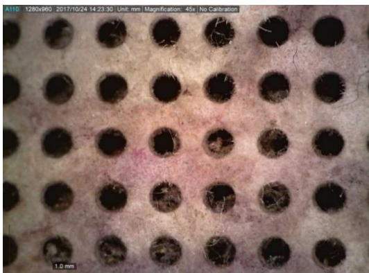
Figura 157 - Fotografia obtida com Dino-Lite do papel perfurado com manchas provocadas por fungos antes da intervenção.
