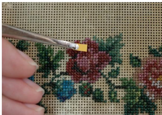
Figura 84 - Medição do pH das missangas do bordado com papel indicador de pH.
