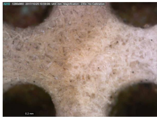
Figura 156 - Fotografia obtida com Dino-Lite do papel perfurado consumido por insetos antes da intervenção.
