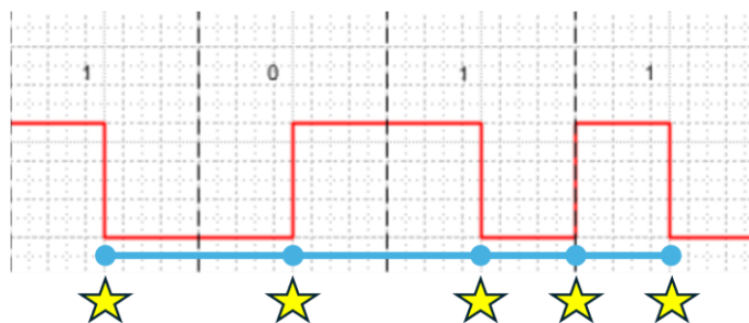
Figura 38 - Momento da captura do tempo de transição entre flancos.
