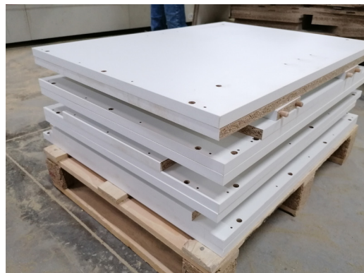
Figura 85. Furação completada pela CNC.
