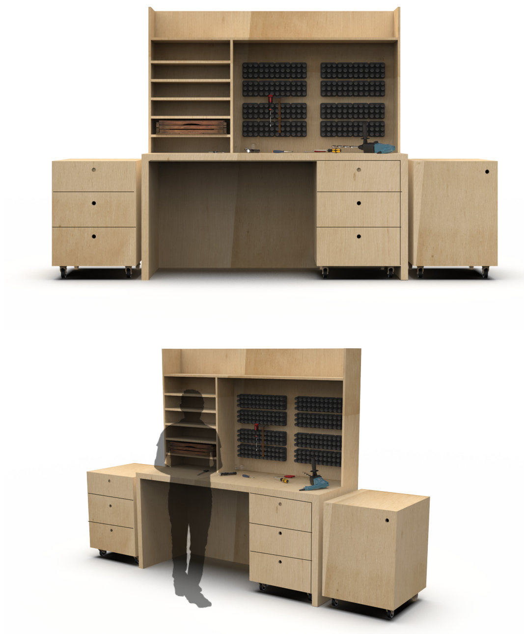
Figura 168. Renders da estação maker com módulos colocados dos lados e representação da escala.
