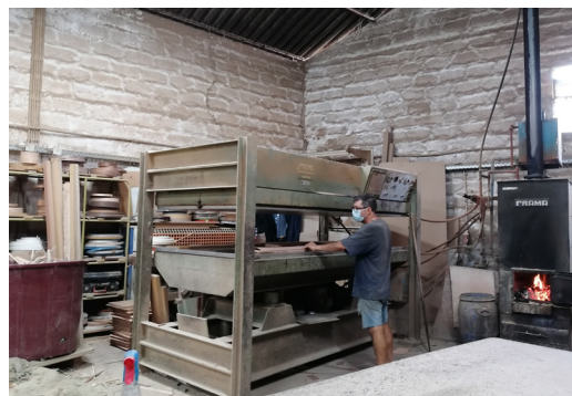
Figura 87. Prensa quente para aplicação de folha de madeira.
