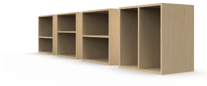
Figura 137. Renders dos módulos com furação a três níveis para colocação de prateleira em diferentes alturas e direções.
