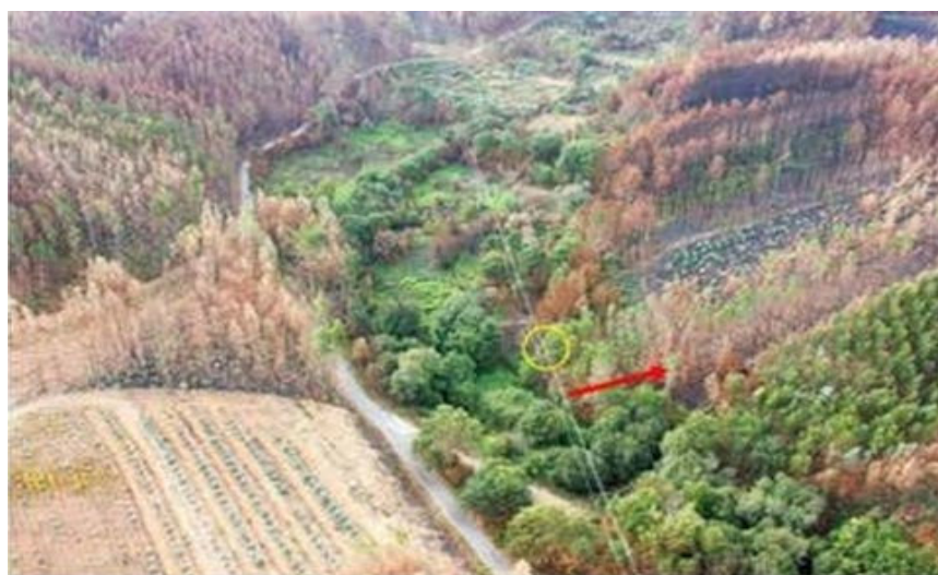
Figura 3.17: Vista aérea do local do incêndio, onde a circunferência a amarelo assinala o ponto de contacto provável entre a linha e a vegetação [14].
