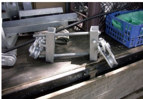
Figura 4.22: Armação para mensageiro.
