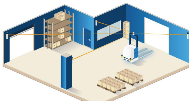
Figura 14 – Robô móvel com tecnologia de localização a laser
