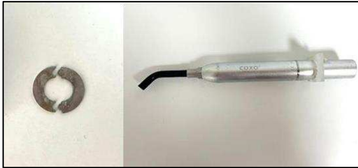
Figura 2. Moldes metálicos e fotopolimerizador, utilizados nos ensaios.
