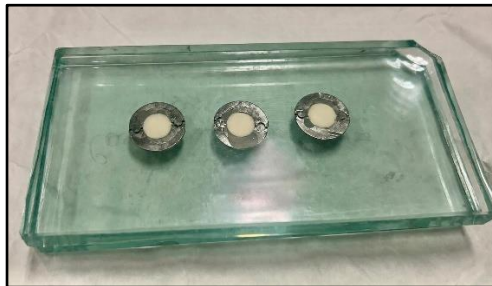
Figura 3. Resinas compostas no interior dos moldes, após fotopolimerização.
