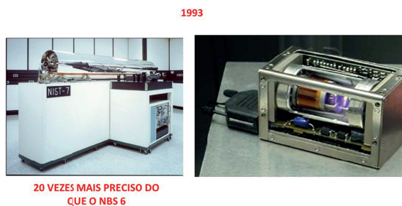
FIGURA 19 Relógios de Césio (NIST7) e de Rubídio (GPS).
