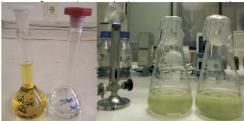
Figuras 4A e 4B – 4A. Preparação das amostras solução-mãe do inibidor dicromato de potássio 2 mg/L; 4B. Preparo e manipulação das amostras teste em condições estéril.
