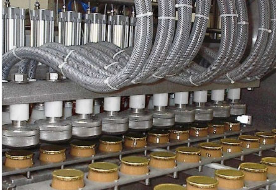
Figura 10 - Cabeças de selagem a selar os copos [9].
