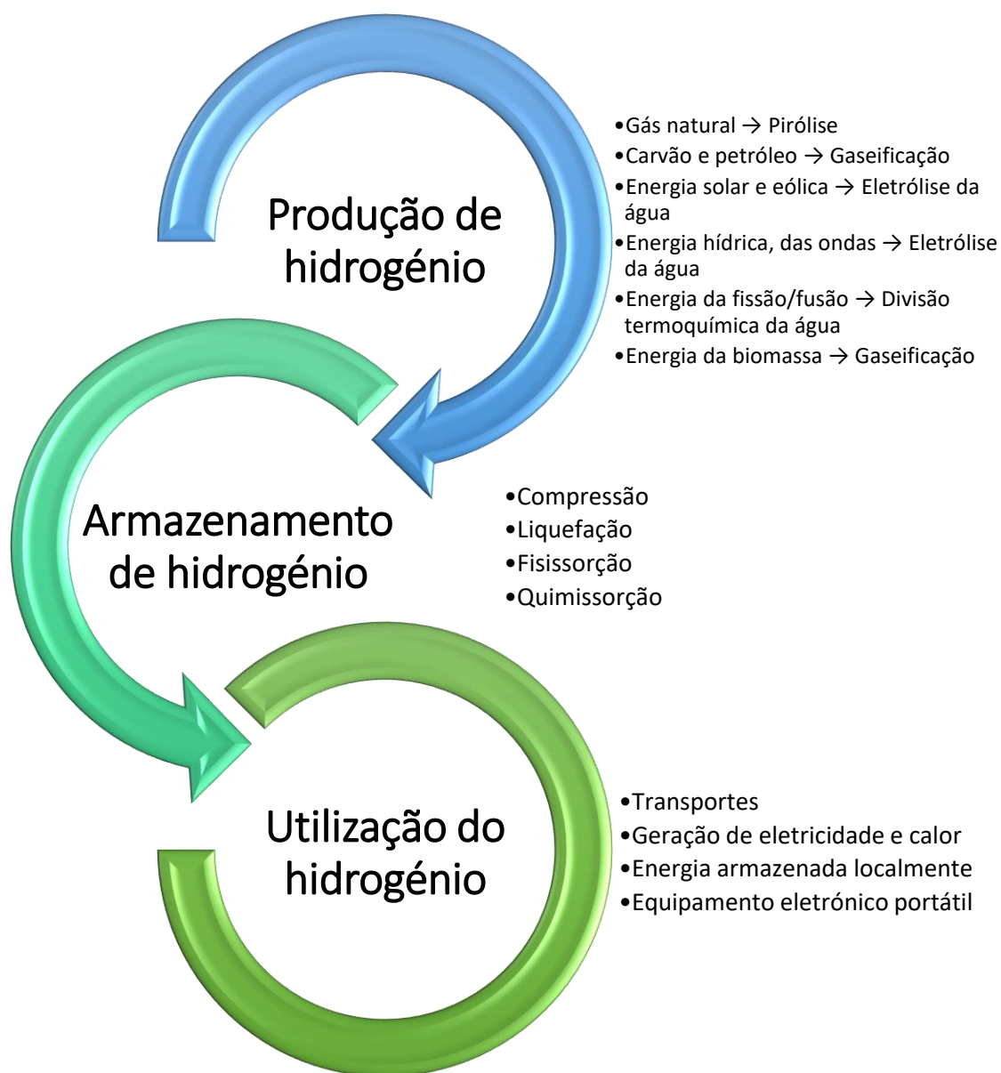
Figura 5: Hidrogénio como vetor energético: origem, opções de produção, opções de armazenamento e diferentes utilizações. Traduzido e adaptado (Abdin et al. , 2020).
