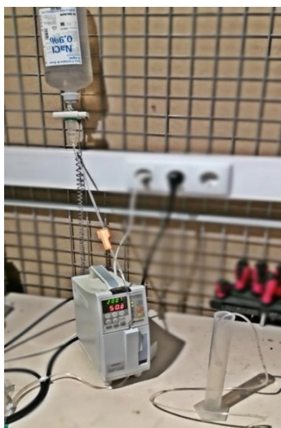
Figura 39 - Medição de volumes de uma Bomba TOP 3300
