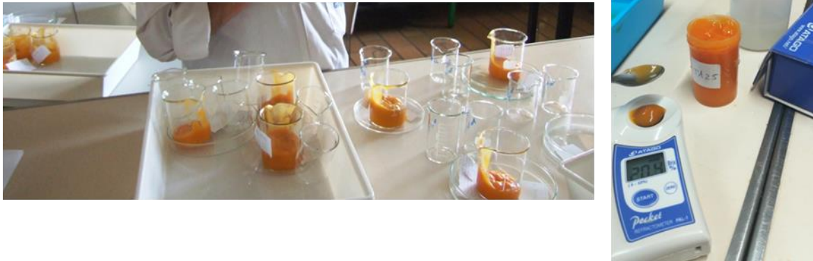
Figura 36. Medição do teor de sólidos solúveis (TSS) usando refratômetro.
