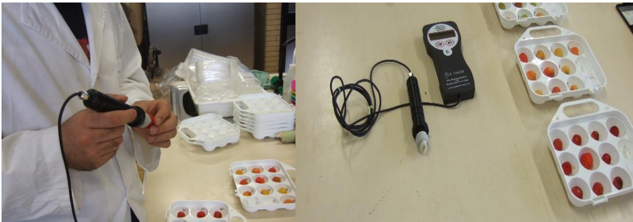
Figura 32. Cálculo da dureza (%), usando o Penetrômetro não destrutivo (DIGITAL FIRMNESS Teste, AGRO TECNOLOGIE)
