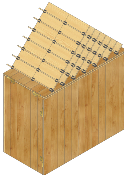
Imagem 385 Módulo com acessório amovível para colocação de garrafas (desenho técnico à escala 1:75 em anexo, folha 10).
