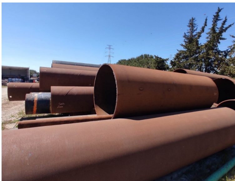
Figura 4 - Exemplo de estacas tubulares
