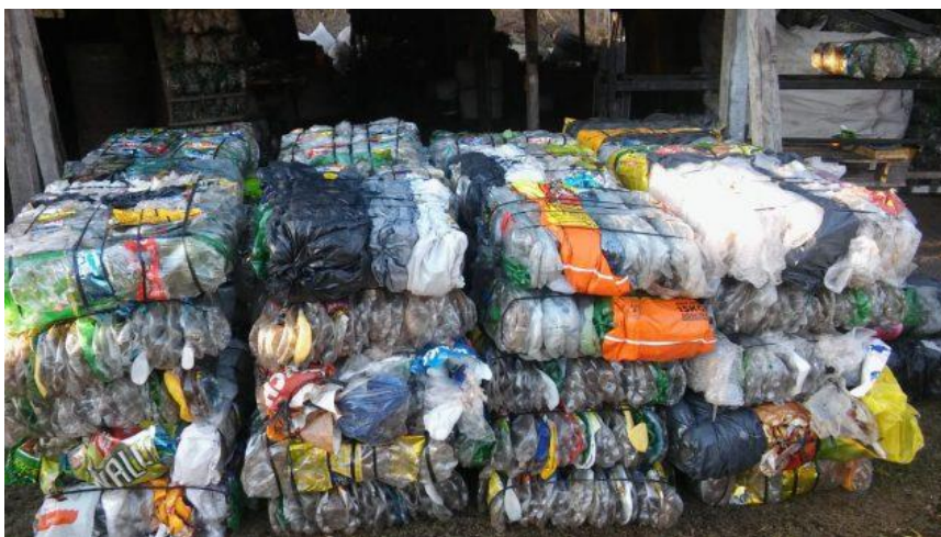
Figura 10 - Plástico previamente prensado e atado, preparado para colocar em obra (Créditos: De Masi (2020))
