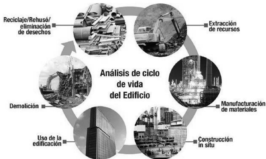
Figura 22 - Esquema de ACV de um edifício (ARQHYS, 2012)
