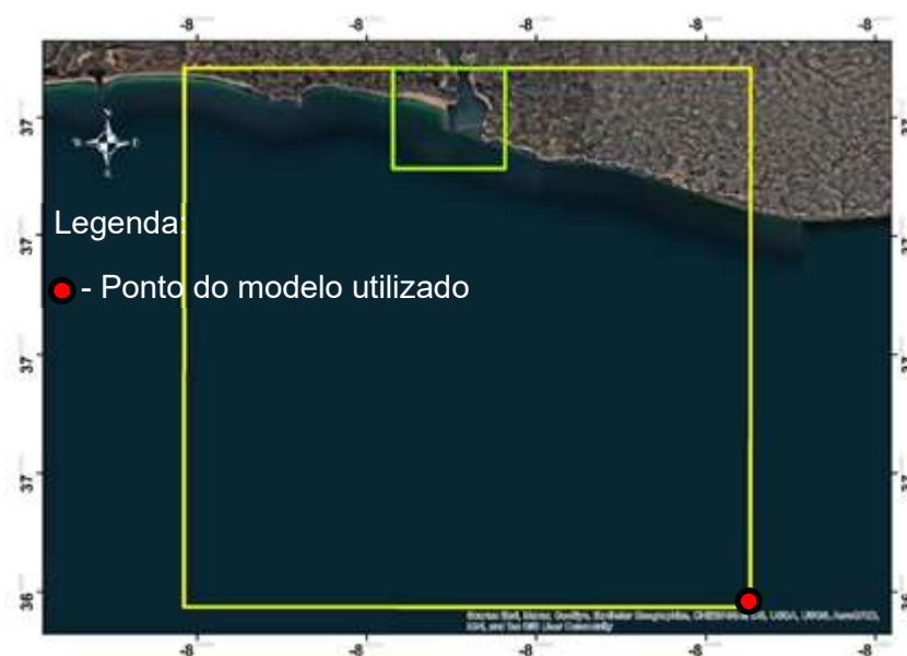
Figura 1-6: Representação das malhas exterior (amarelo) e interior (verde) para Portimão (Retirado de Madeira, 2021)
