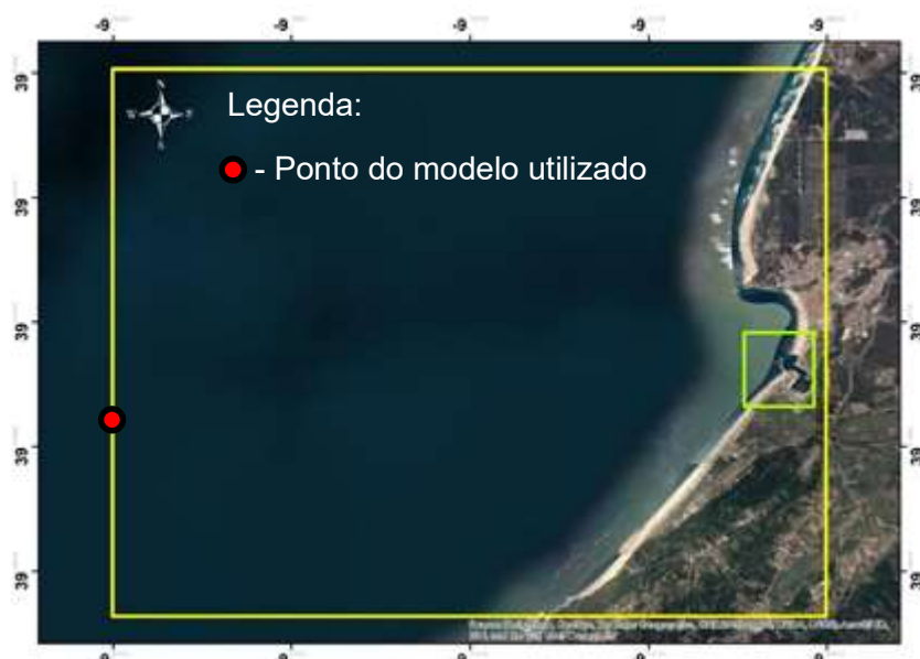
Figura 1-5: Representação das malhas exterior (amarelo) e interior (verde) para a Nazaré (Retirado de Madeira, 2021)
