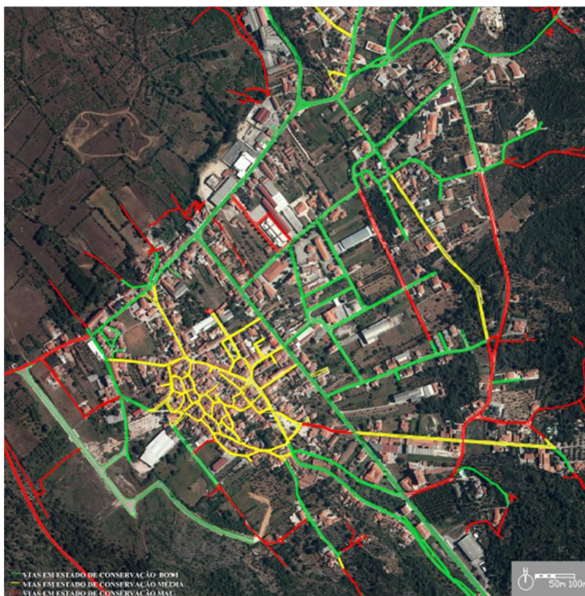
Figura 45 – Mapa do Estado de Conservação dos Pavimentos Exemplos do
